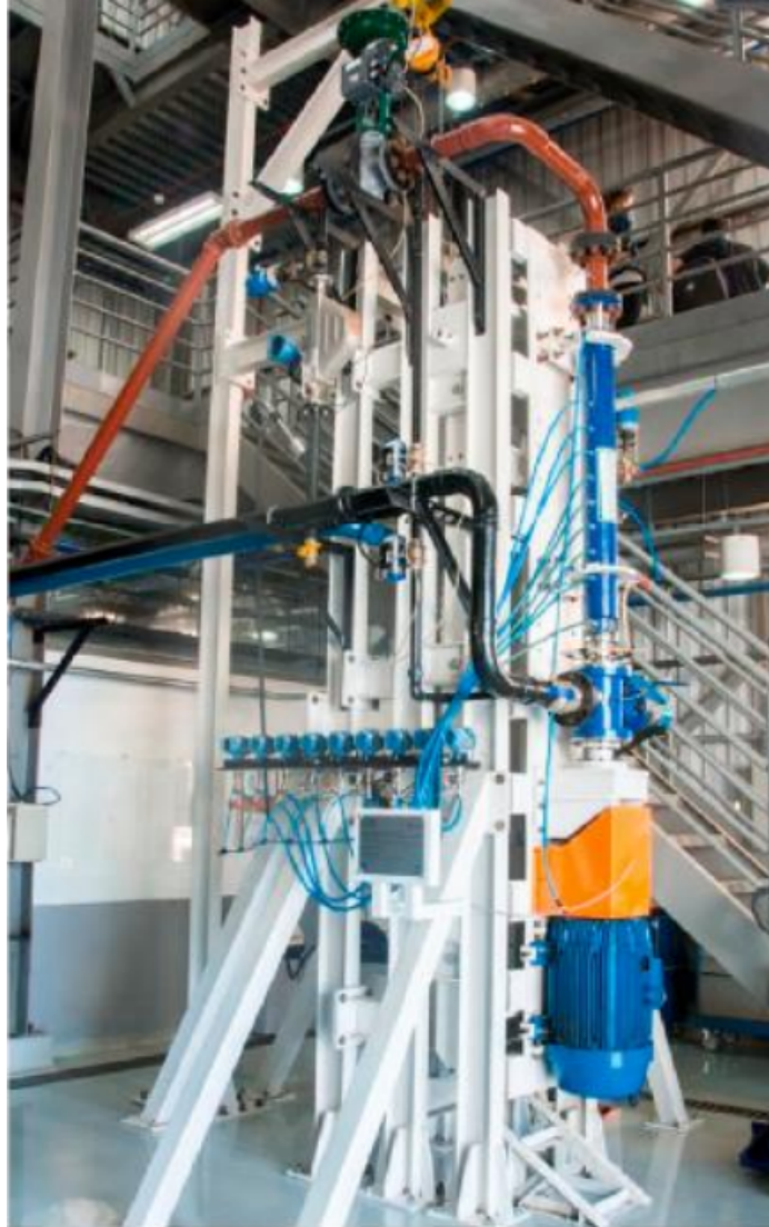
Figure 5 – Pump System Testbench - Source: Teste de desempenho de BCS e monitoramento de parâmetros elétricos - CEPETRO (2025)
