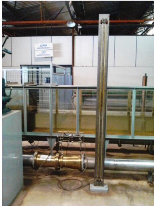
Figura 3. 17: Medidor de vazão por Venturi e manômetro tipo tubo em “U”.
