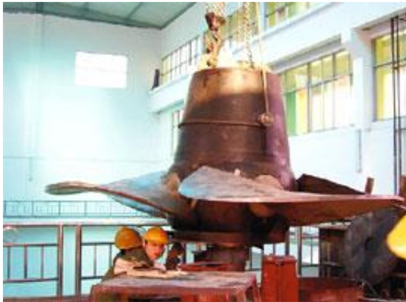
Figura 2. 8: Rotor de uma das turbinas da usina de Jiangxia. Fonte: ( http://www.hj1956.com/en/p34.html ; acessado em 13/11/2012 ).
