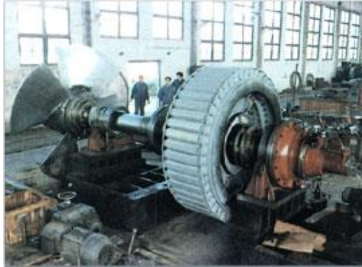
Figura 2. 9: Conjunto gerador de 700 kW da usina de Jiangxia. Fonte: ( http://www.hj1956.com/en/p34.html ; acessado em 13/11/2012).
