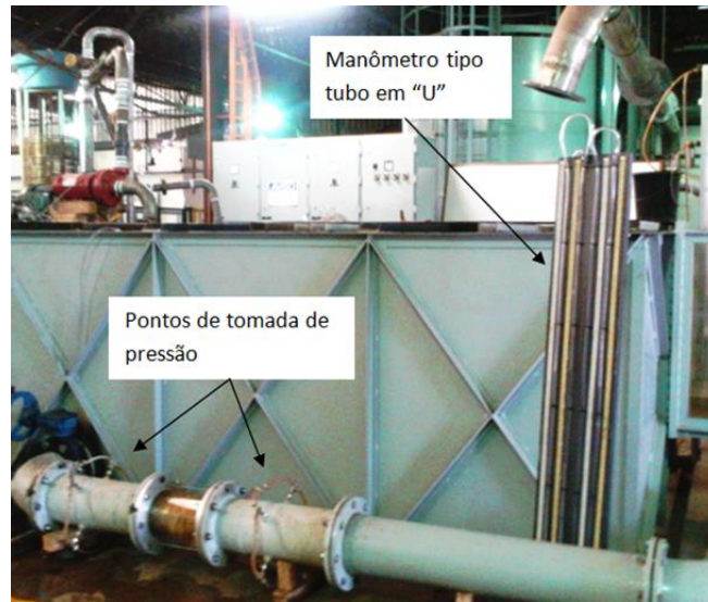
Figura 3. 18: Tomada de medida de pressão a montante e a jusante do modelo.
