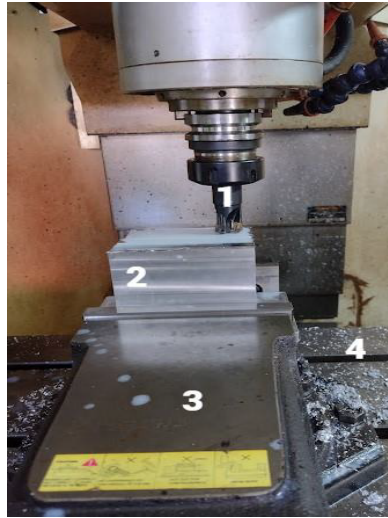
Figura 11 - Montagem do corpo de prova: (1) ferramenta; (2) corpo de prova; (3) dispositivo de fixação do corpo de prova; (4) mesa da fresadora.
