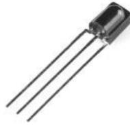
Figura 4.5 – Receptor infravermelho.
