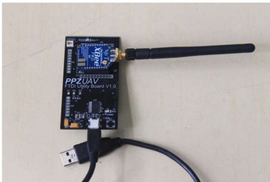
Figura 23 - Placa FTDI e modem de comunicação Fonte: autoria própria.
