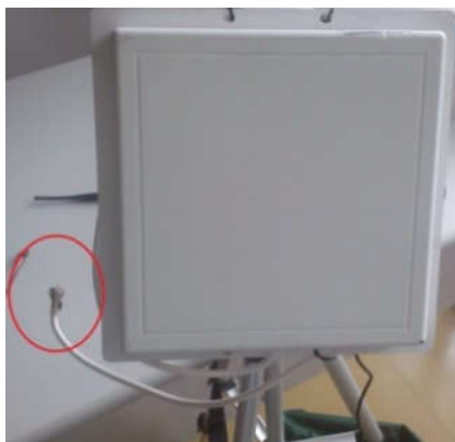
Figura 28 - Antena patch de 8dbi Fonte: autoria própria.
