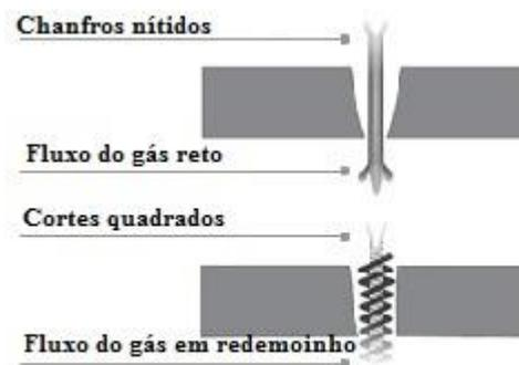
Figura 2.13: Fluxo do gás do corte por plasma
