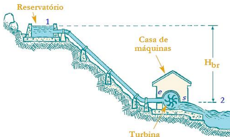
Figura 2.1 - Queda bruta ( H_{br} ) em um aproveitamento hidrelétrico. Modificado de (NRC, 2004).
