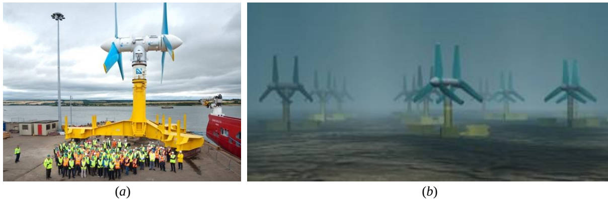
Figura 4.24 - Sistema AK-1000 de 1 MW da empresa Hallin Marine Subsea International Ltd. (a) Vista geral do sistema, (b) projeção de uso em arranjos.
