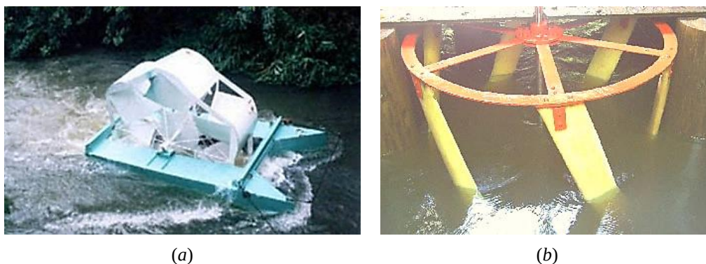
Figura 2.17 - Alguns sistemas hidrocínéticos propostos no Brasil. (a) Roda d'água e (b) projeto piloto no Estado do Pará.
