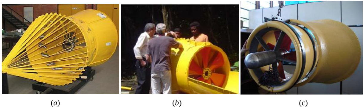
Figura 2.16 - Turbina desenvolvida na Universidade de Brasília. (a) Primeira, (b) segunda e (c) terceira geração.
