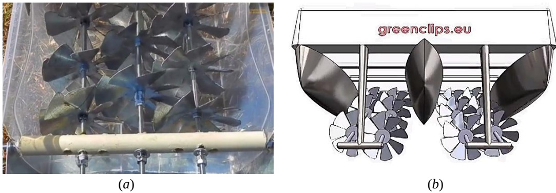
Figura 2.21 - Sistemas multiestágio baseados no conceito do inventor Tonchev. (a) Pequeno modelo do sistema com três eixos de rotores superpostos, (b) representação gráfica do sistema flutuante.
