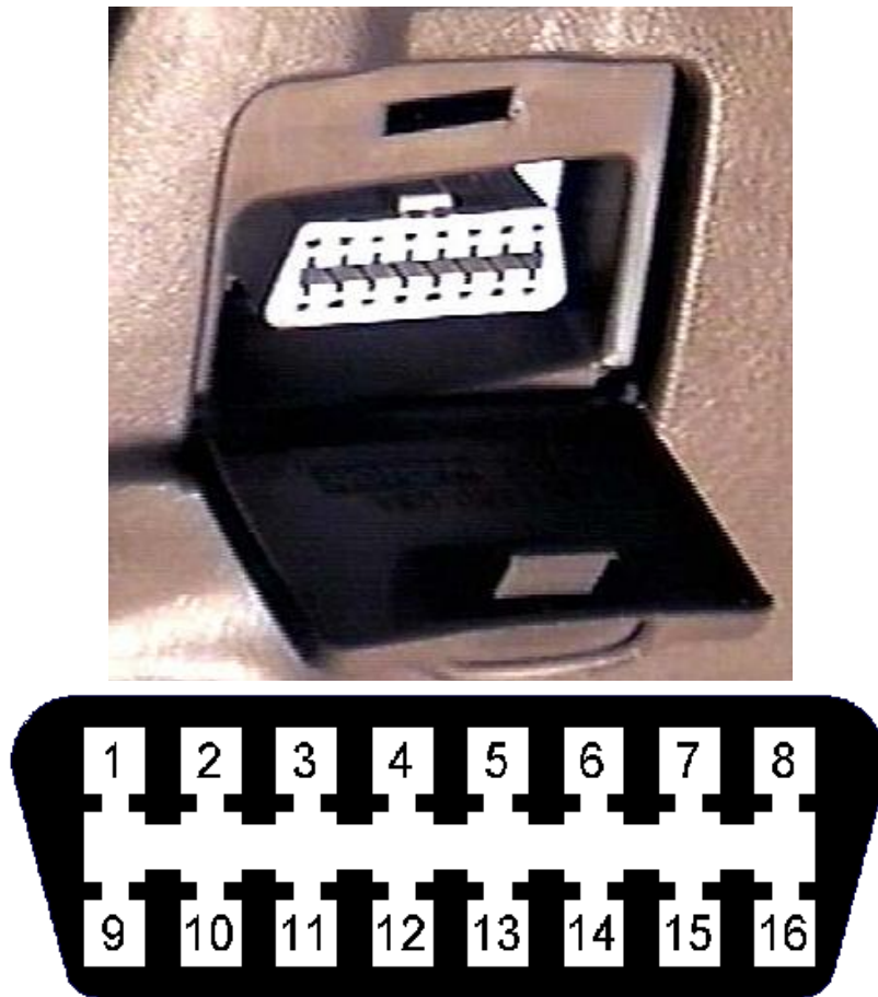
Figura 29 - Conector Padrão do OBD (EPA, 2013)
