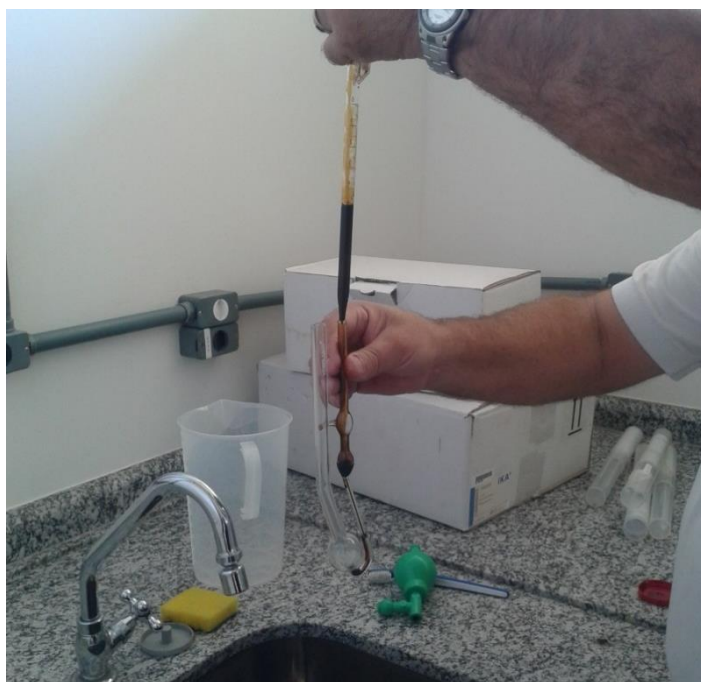
Figura 5. 7 Detalhes da Medição do OPU no viscosímetro de Ostwald
