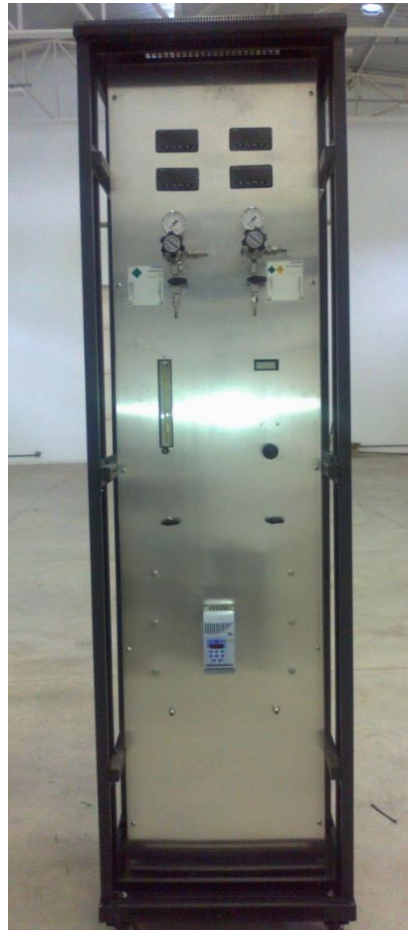
Figura 6. 13 Bancada, vista frontal, com as válvulas de posto, rotâmetro, medidor de vazão de ar, válvulas agulha, válvulas esfera abre-fecha inversor de corrente e os indicadores.
