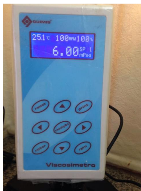
Figura 5. 8 Medição do OPPU no viscosímetro de rotação
