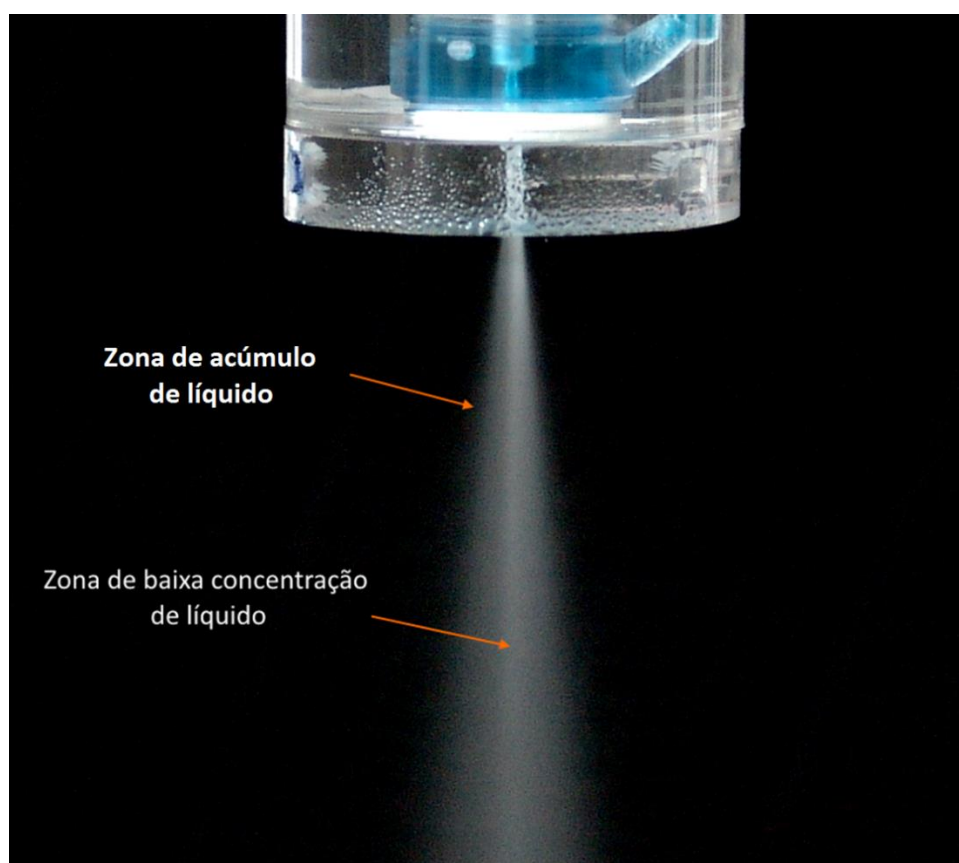
Figura 7. 8 Distribuição de gotas no injetor Y utilizando água colorida.
