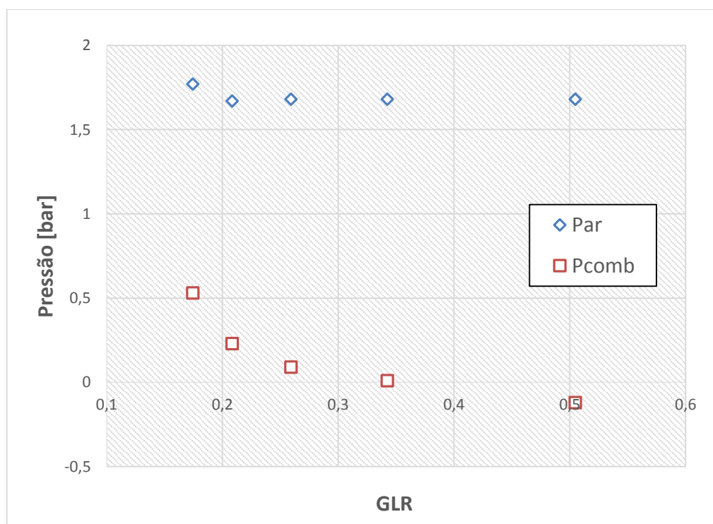
Figura 7. 13. Pressões nas linhas do injetor Y em aço, com 3,5 l/min de ar e óleo de soja.
