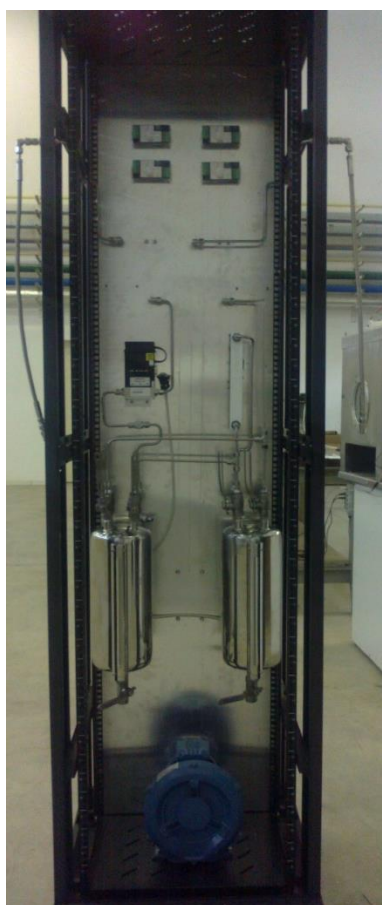
Figura 6. 12 Bancada vista posterior, com as linhas de combustível, e ar finalizadas, além do compressor e os indicadores.
