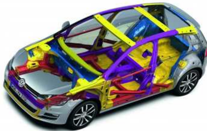
Figura 0.4 - Peças estampadas a quente em um típico carro compacto. Estrutura de segurança do Golf VII Fonte: STAHL-ZENTRUM, 2016 (Volkswagen Media Services).
