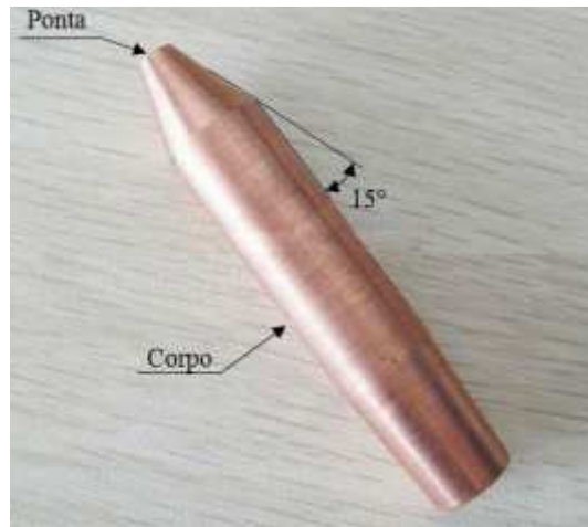
Figura 0.2 - Eletrodo de cobre modelo TW 5/8 reto com ponta, marca PRESOL. Fonte: Baldim (2014).
