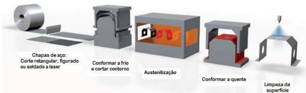
Figura 0.8 - O processo indireto otimizado. Fonte: voestalpine AG (2016).
