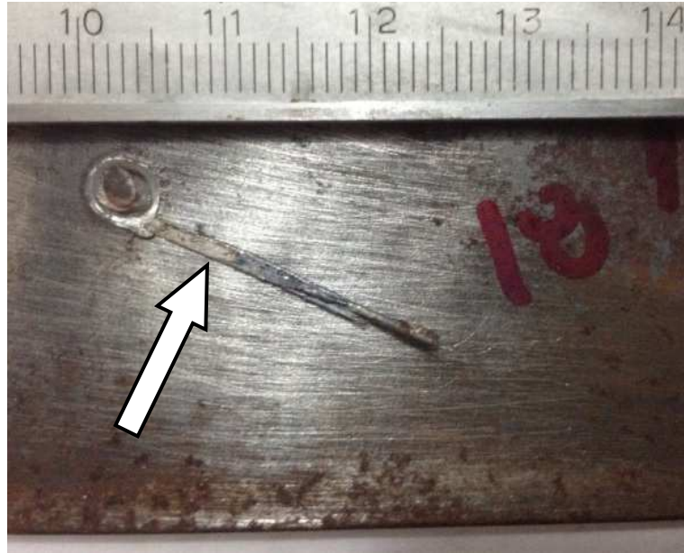
Figura 0.12 – Expulsão de material na interface interna (entre as chapas de aço). Ponto de solda feita numa junta de aço 22MnB5. A seta aponta os metais que foram projetados no estado líquido e rapidamente solidificados. Fonte: Autor (2016).
