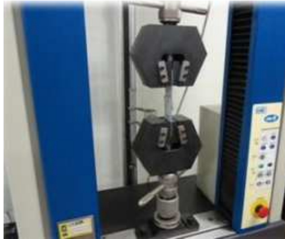
Figura 0.6 - Máquina de Ensaio Universal EMIC DL 2000. Laboratório de ensaios destrutivos – IEM/UNIFEL. Velocidade de ensaio 1,25 mm/min. Fonte: Autor (2016).
