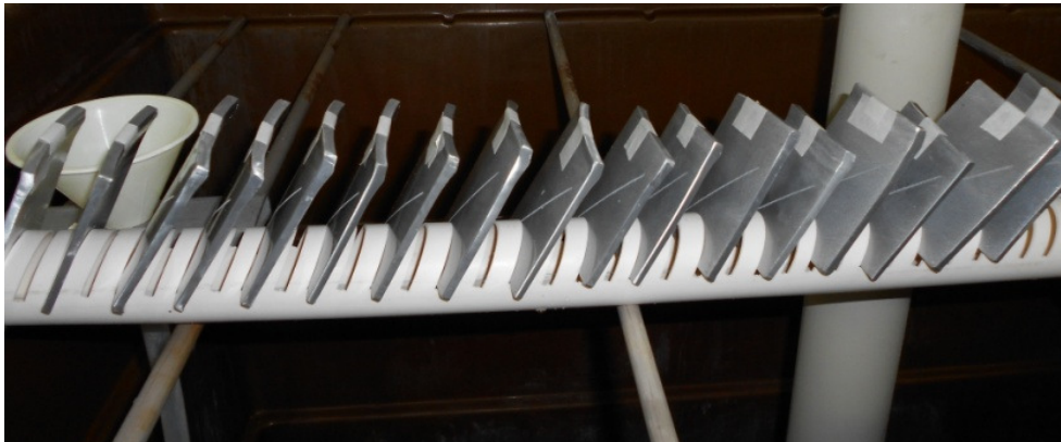
Figura 34: Posicionamento das peças na câmara de Cass Test
