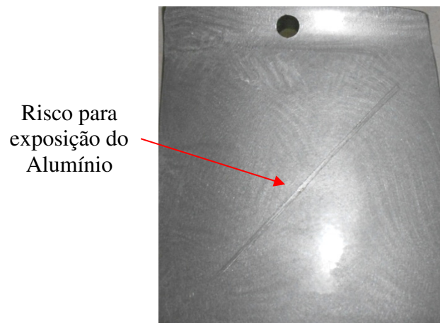
Figura 33: Corpo de prova envernizado e riscado para exposição do alumínio
