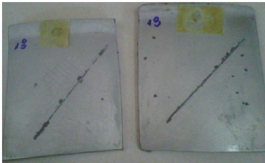
Figura 37: Formação de bolhas no verniz após a exposição ao Cass Test
