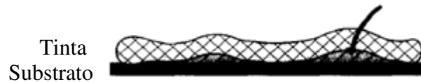
Figura 8: Representação esquemática da seção transversal dos produtos de corrosão sob um revestimento orgânico
