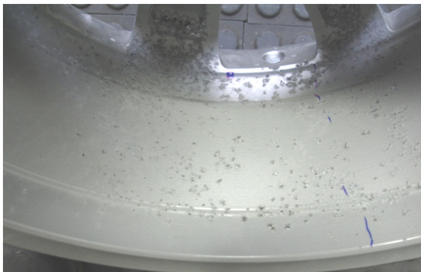
Figura 2: Formação de bolhas sob camada de tinta em fundida após exposição ao Cass Test .
