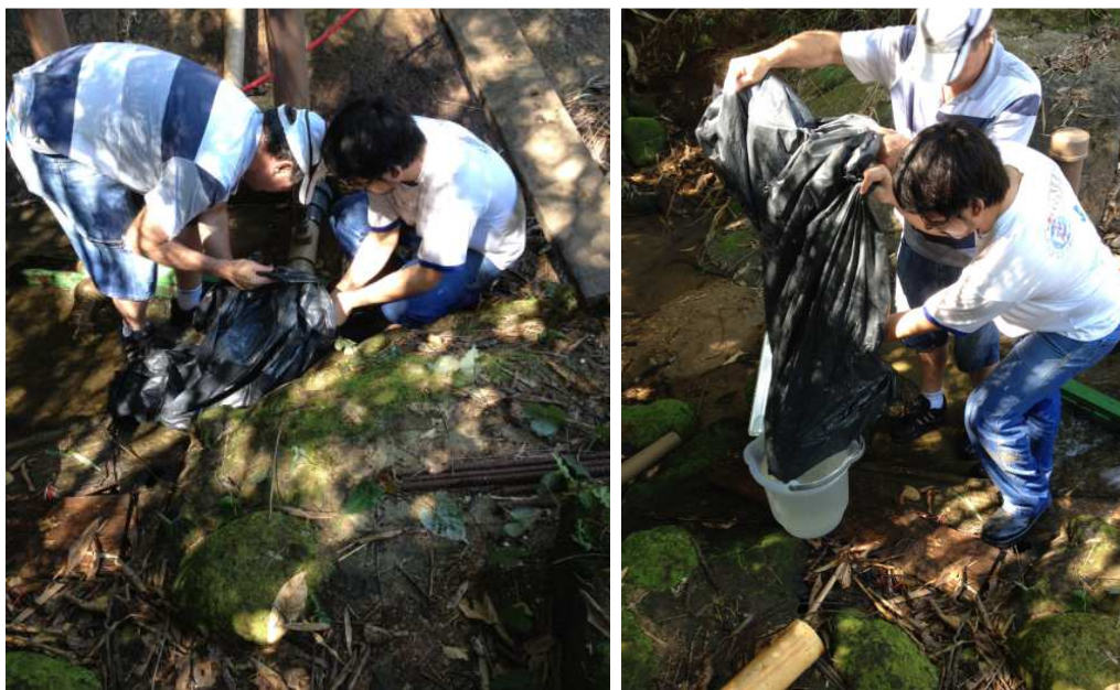
Figura 4.57- Captação e medida do volume de água perdida no processo de funcionamento do carneiro hidráulico
