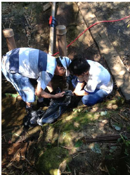
Figura 3.21- Medição da vazão perdida no processo de funcionamento dos carneiros hidráulicos com a utilização de sacos plásticos
