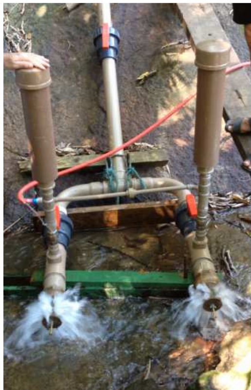
Figura 4.56- Carneiros hidráulicos em funcionamento
