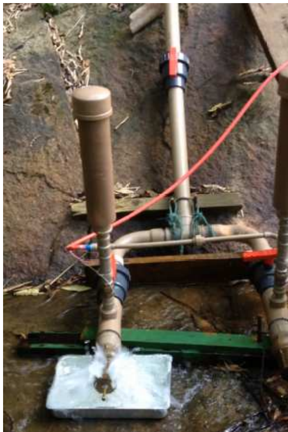
Figura 3.19- Tentativa de medir a vazão perdida no processo de funcionamento dos carneiros hidráulicos com a utilização de uma assadeira de alumínio
