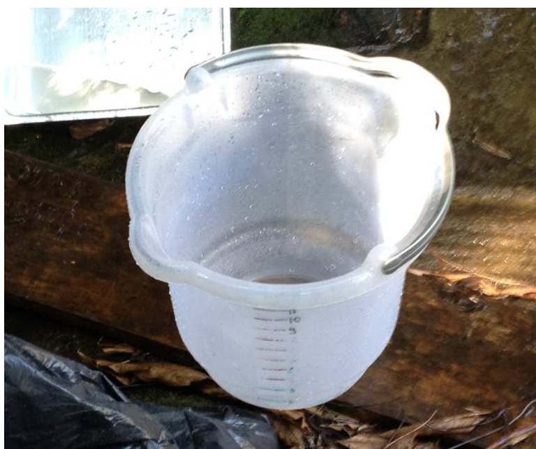
Figura 3. 9- Recipiente graduado e calibrado utilizado na medição de vazões
