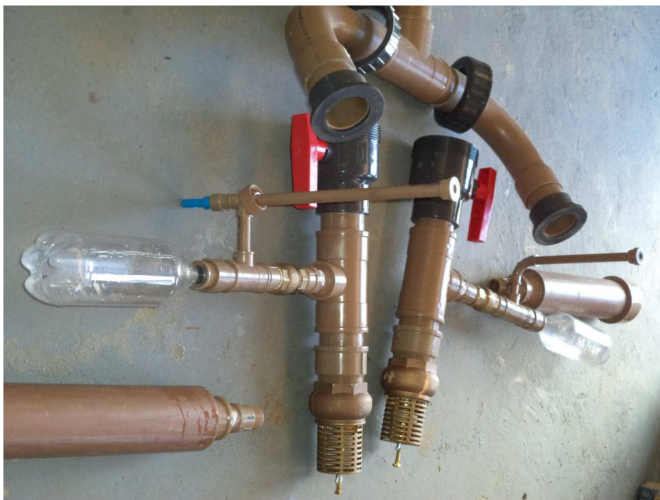
Figura 4.51- Montagem dos carneiros hidráulicos com campânula de garrafa PET
