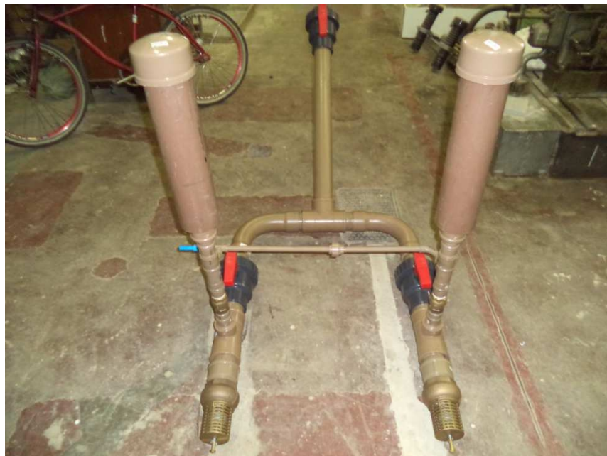
Figura 4.53- Carneiros Hidráulicos montados
