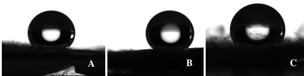
Figura 3.19 – Gota de água em contato com as fibras poliméricas: (a) PMAA (b) PMAA / poliβCD (80:20) (c) PMAA / poliβCD (95:5) com LOS
