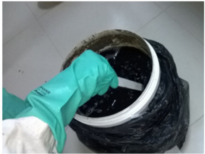
Figura 13: Lodo bruto retirado de uma das estações de tratamento de esgoto (Fonte: autor)
