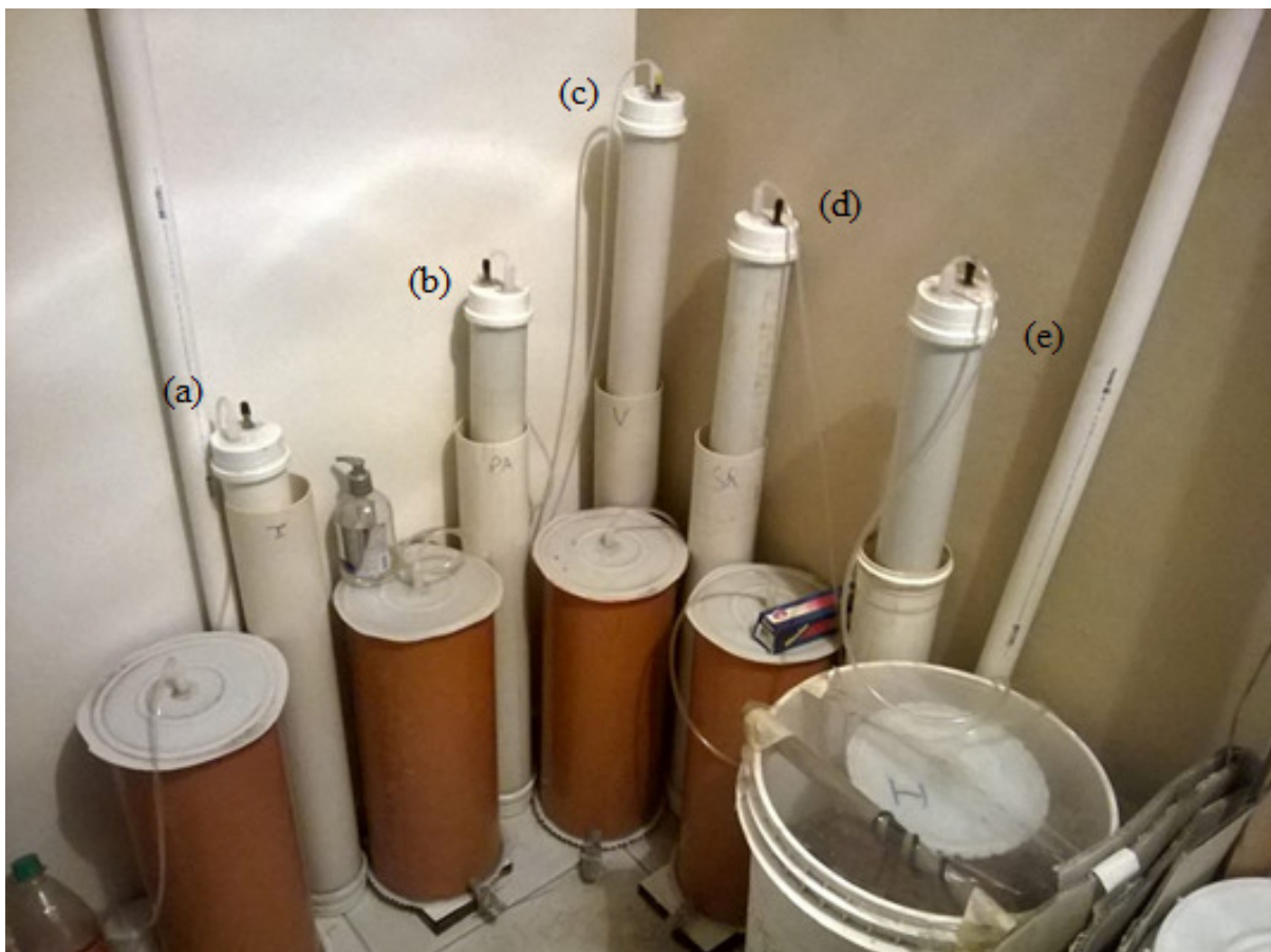
Figura 09: Digestores e gasômetros pilotos para (a) Itajubá (sem aquecimento), (b) Pouso Alegre, (c) Varginha, (d) Santa Rita do Sapucaí e (e) Itajubá (com aquecimento). (Fonte: autor).
