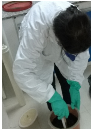
Figura 14: Lodo bruto inserido no reator antes da lacração (Fonte: autor)
