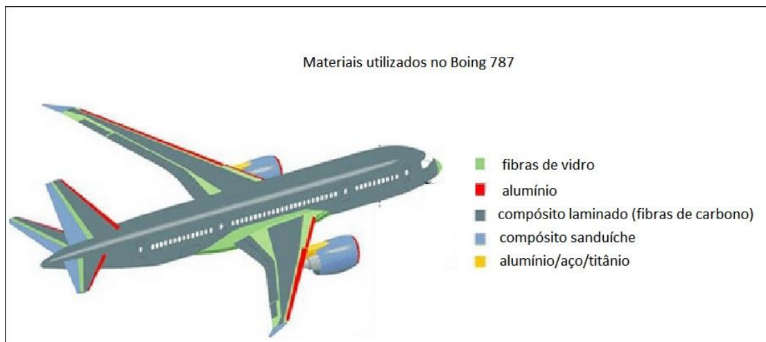
Figura 2.2 – Tipos de materiais utilizados no Boeing 787(Fonte: Adaptado do site da Boeing)
