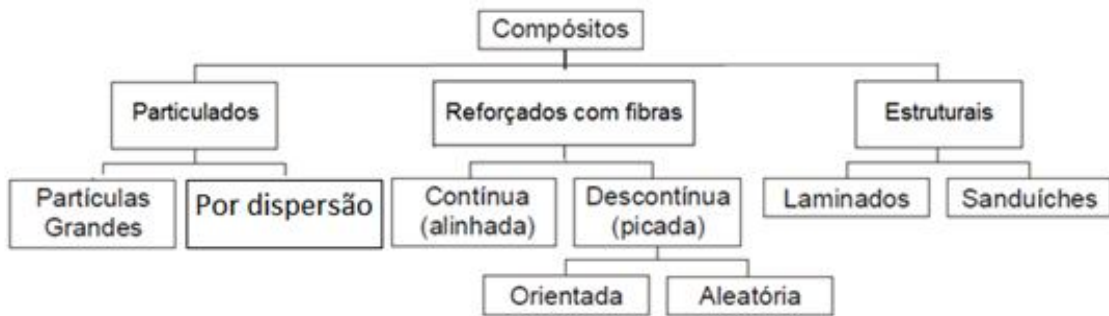
Figura 2.3 – Classificação dos materiais compósitos (Adaptado de: Tita (1999) apud Diacenco (2010)).
