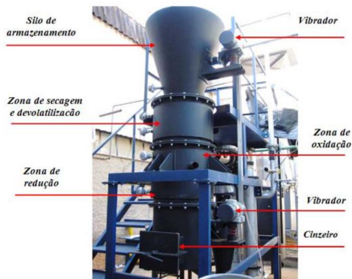
Figura 9 – Gaseificador de leito fixo de duplo estágio adaptado para a injeção de vapor e oxigênio descrito por Martínez et al.(2011)
