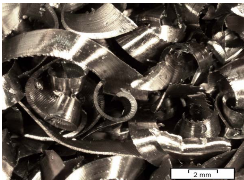
Figura 4.1 – Cavaco do aço X22CrMoV12-1, ampliação 10x
