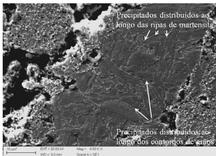
Figura 5.32 – Microestrutura após sinterização e tratamentos térmicos na condição com adição 3% NbC
