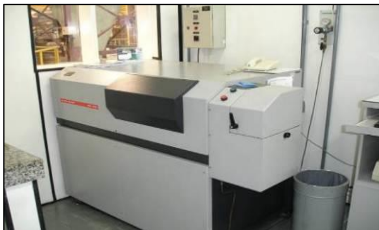
Figura 13 - Espectrômetro ótico THERMO SCIENTIFIC, modelo 3460 FAA.
