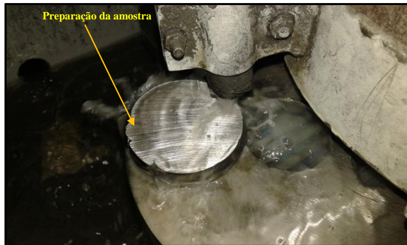
Figura 28 - Preparação da superfície na retifica HERZOG.
