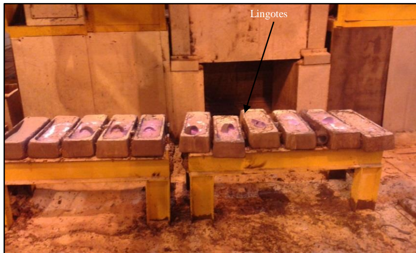
Figura 36 - Lingotes de material retirado da carga met\~alica
