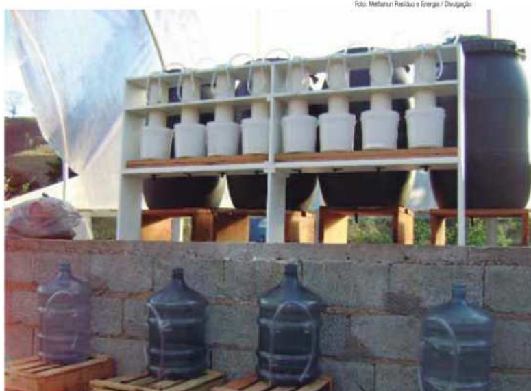
Digestores anaeróbios em escala piloto (recipientes de 200 litros), gasômetros para medição do biogás (confeccionados com tubos de PVC brancos) e sistema para coleta de percolado (galões de 20 litros).
