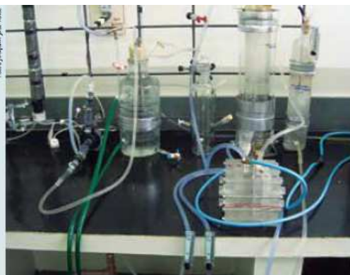
Sistema eletroquímico para a produção de ozônio
