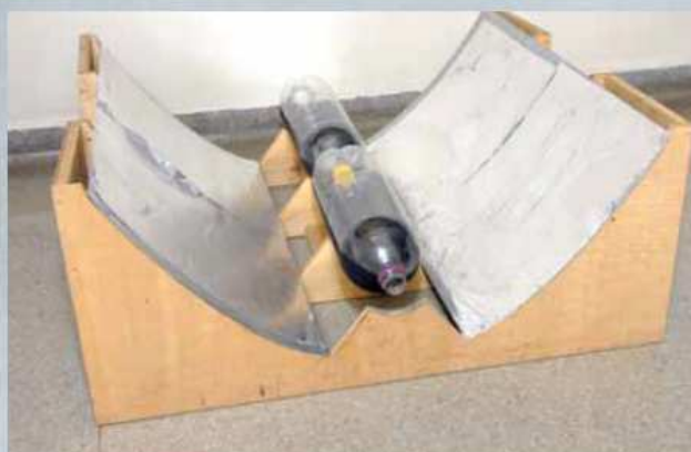
Um concentrador solar feito de madeira e chapas refletoras potencializa a ação dos raios solares que irão descontaminar a água
