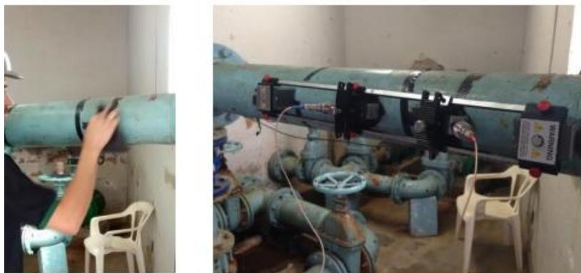
Figura 17 - Preparação e instalação do medidor ultrassônico
