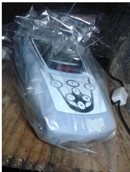
Figura 22 - Medidor de vazão instalado no Poço de Visita.
