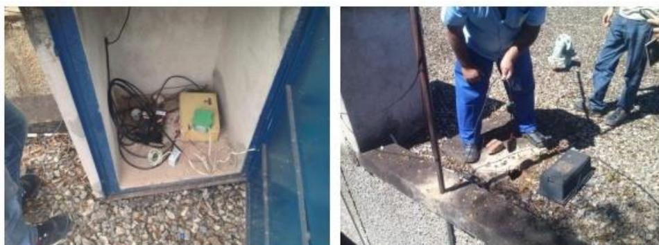
Figura 15 - Conexão do medidor de nível ao DATA logger
