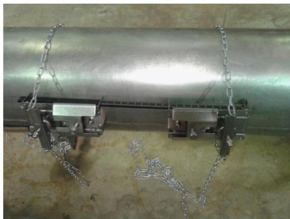
Figura 9 - Sensores do medidor de vazão instalados para teste.
