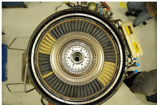
Figura 2.4 Ensaio de pás feitas a partir de compósitos de matriz cerâmica
