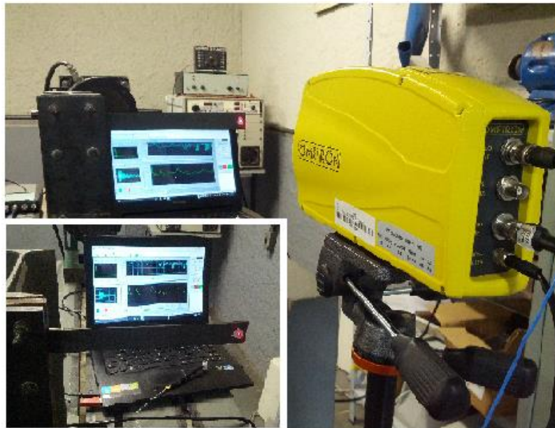
Figura 3.7 Disposição dos equipamentos para o ensaio de vibração engastado-livre. Fonte: Autor.
