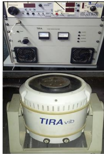
Figura 3.8 Aparelhos para o Ensaio de Vibração forçada. Fonte: Autor.
