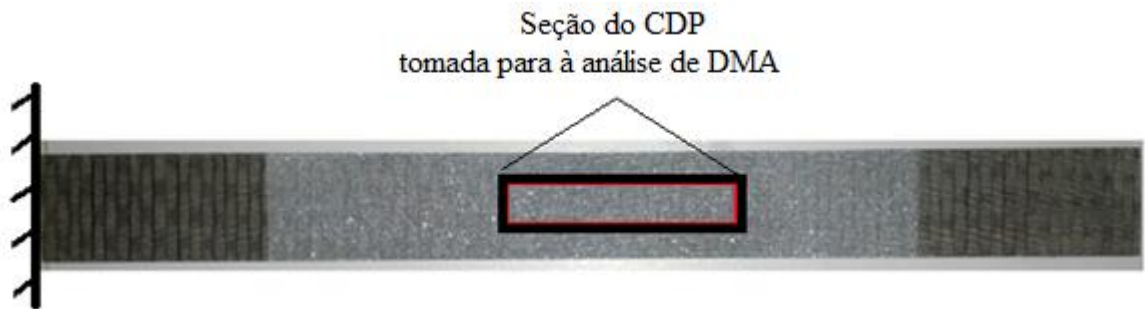
Figura 3.12 Seção tomada para obter as amostras para à análise de DMA.
