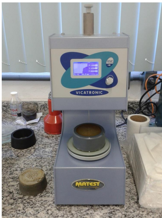
Figura 35 - Ensaio de tempo de pega.
