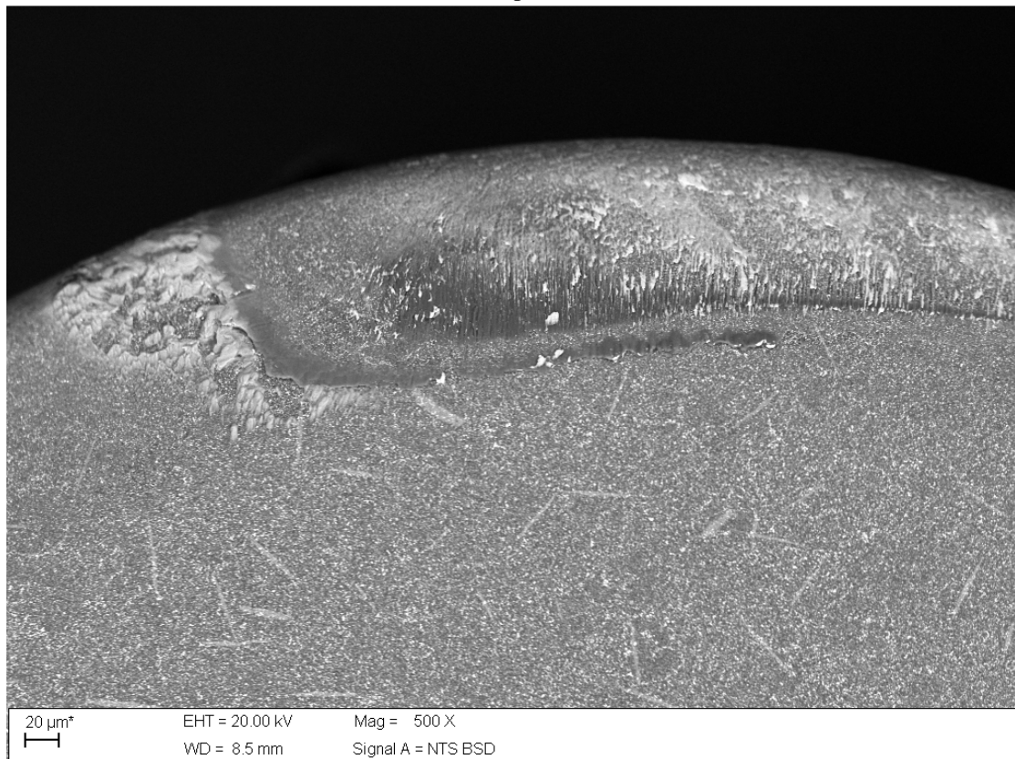
Figura 69: MEV da aresta de corte / superfície de saída – Superfície do inserto – Vc=137 m/min; f=0,09 mm/rev; ap=0,3mm.
