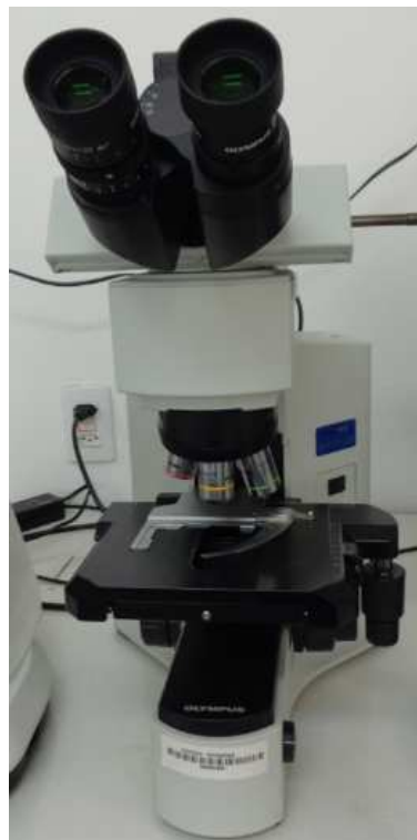
Figura 12: Microscópio óptico – OLYMPUS – BX41M-LED com recurso para captura de imagens.
