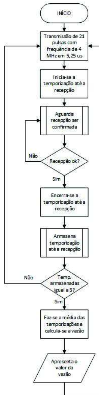
Figura 41 – Fluxograma básico para medição da vazão baseado no tempo de trânsito com sinal ultrassônico.
