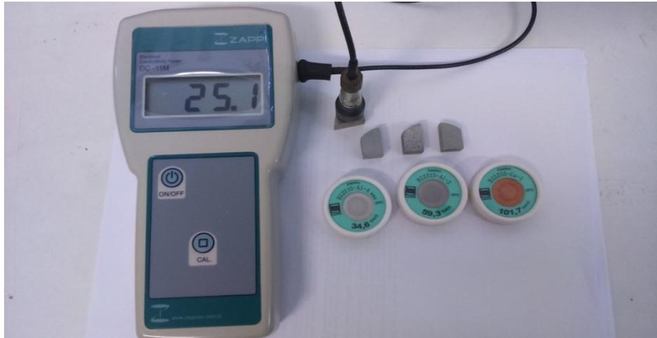
Figura 3.23 Condutivímetro digital de contato da marca Zappi modelo DC-11M e Padrões de calibração do LMM – UNIFEI..
