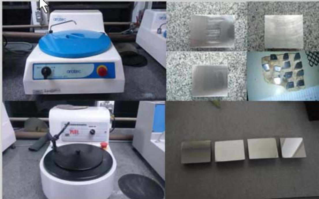
Figura 3.15 Equipamentos de lixamento e polimento das amostras (AROPOL 2V 2000 E 300MM) do LMM - UNIFEI..
