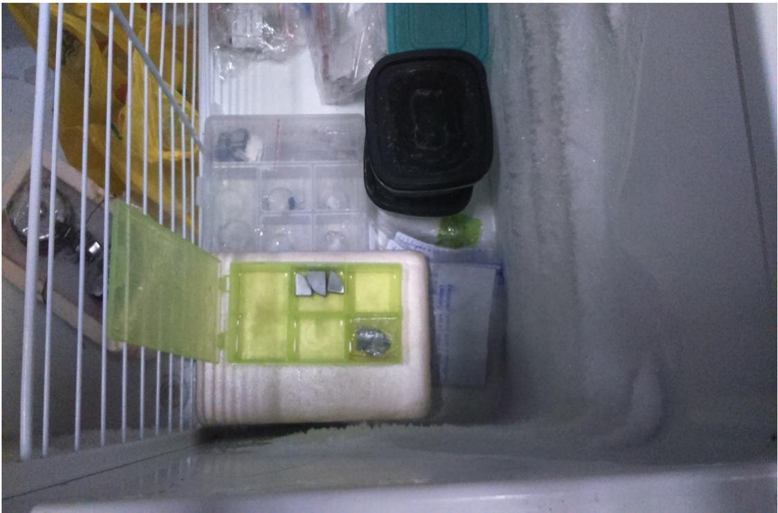
Figura 3.12 Amostras da liga Al 7075 solubilizadas armazenadas no Freezer METALFRIO modelo DA550
