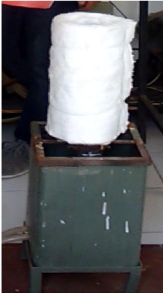
Figura 3.8 Casca cerâmica envolta por manta cerâmica. (Condição A)
