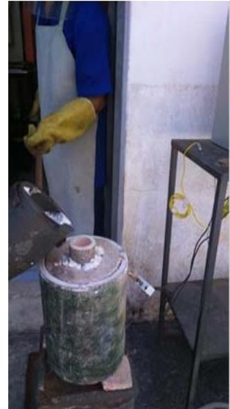
Figura 3.9 Casca aquecida em dispositivo com resistência elétrica tipo Kanthal. (Condição B)
