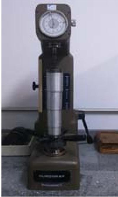
Figura 3.19 Durômetro marca Durograf SB N° 80. do LMM – UNIFEI
