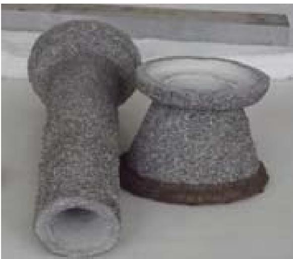
Figura 3.6 Molde cerâmico a base de zirconita
