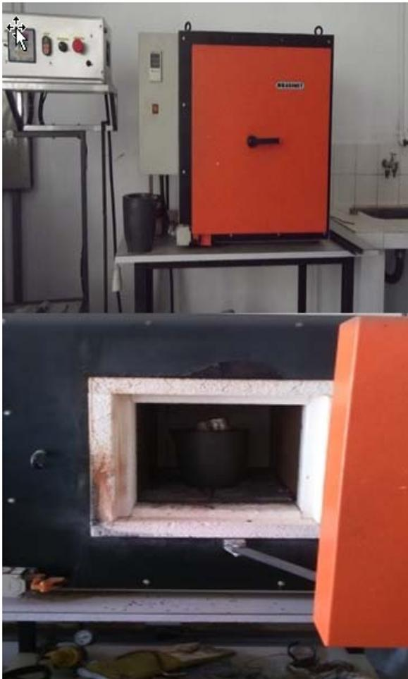
Figura 3.4 Forno elétrico da marca Brasimet do tipo câmara, modelo K-250 do LMM - UNIFEI.
