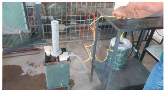
Figura 3.7 Coquilha de cobre refrigerada a água
