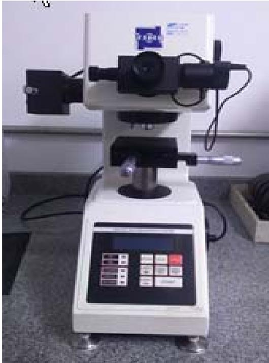
Figura 3.21 Micro-durômetro Vickers marca Time modelo TH 712 do LMM – UNIFEI.
