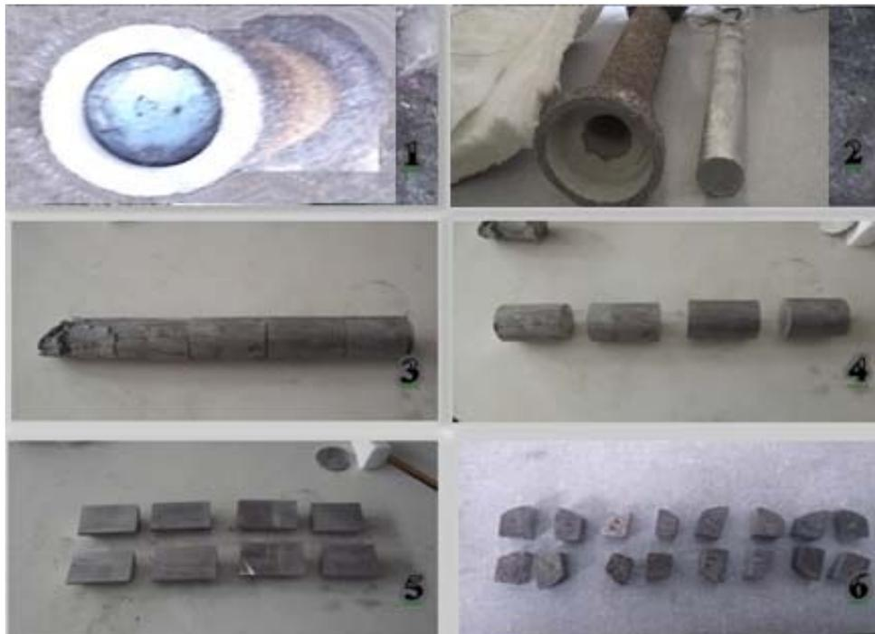
Figura 3.13 Desmoldagem após a solidificação e corte das amostras da liga Al 7075.
