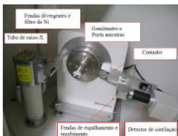
Figura 3: Goniômetro utilizado na caracterização da estrutura cristalina dos pós cerâmicos de YFeAl.
