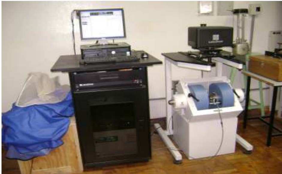
Figura 5: Princípio de funcionamento do Magnetômetro de Amostra Vibrante do Laboratório de Ensaios Destrutivas e Não-Destrutivas da UNIFEI
