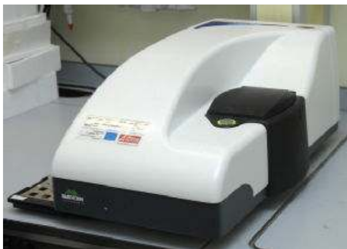
Figura 6: Ilustração do equipamento Malvern nano ZS para determinação do diâmetro das nanopartículas DGEBA/YFeAl e DGEBA/YFeAl/ZnS e DGEBA/YFeAl/Rh.
