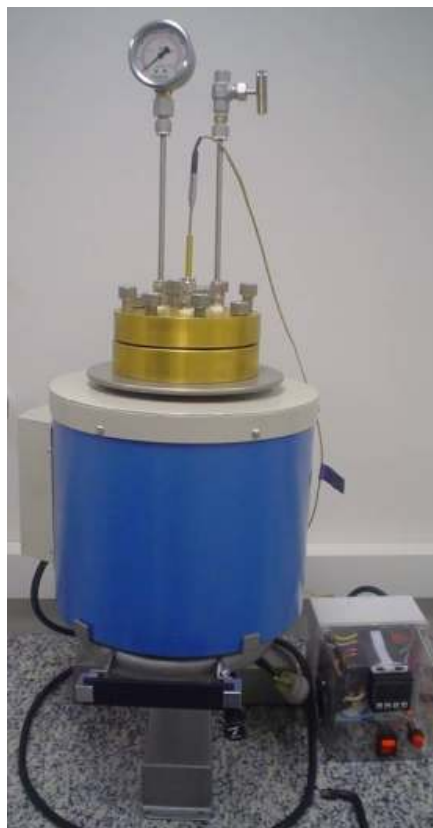
Figura 5: Ilustração do modelo de reator utilizado na síntese de nanopartículas de ZnS.
