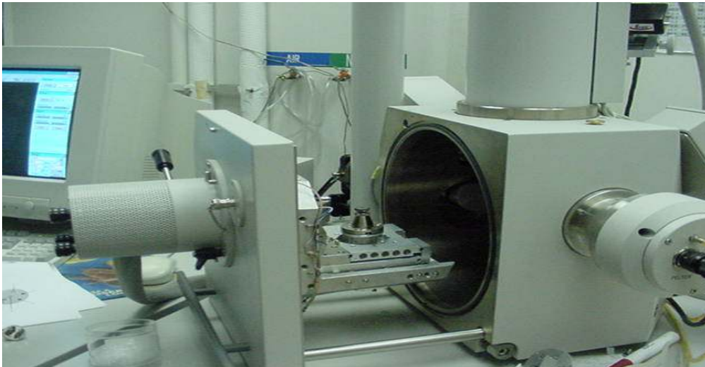
Figura 1: Microscópio Eletrônico de Varredura – com a câmara de amostras aberta.
