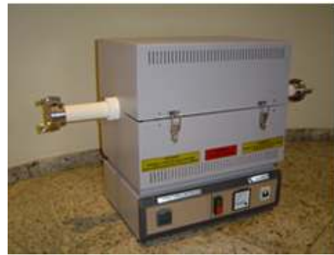
Figura 1: Ilustração do tipo de reator e forno tubular utilizados na síntese das nanopartículas de YFeAl.
