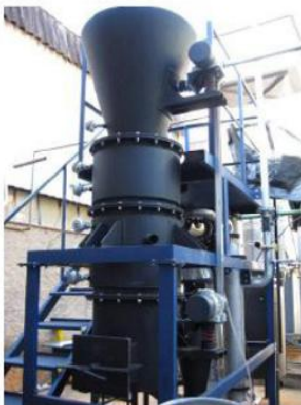
Figura 4.5 Ilustração de um gaseificador de Leito Fixo (Andrade, 2013).
