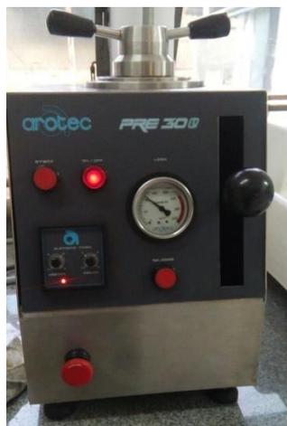
(a) Prensa hidráulica para embutimento a quente
