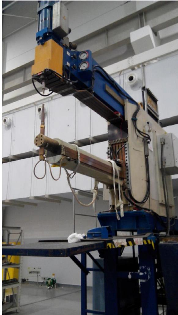
Figura 2.4 – Equipamento de soldagem do tipo estacionário
