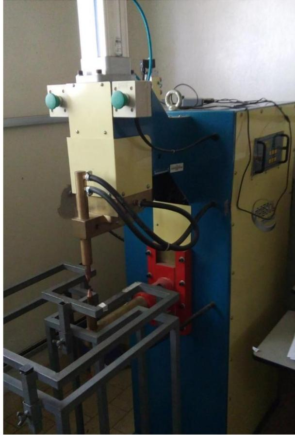
Figura 3.3 – Máquina estacionária de soldagem a ponto por resistência elétrica utilizada
