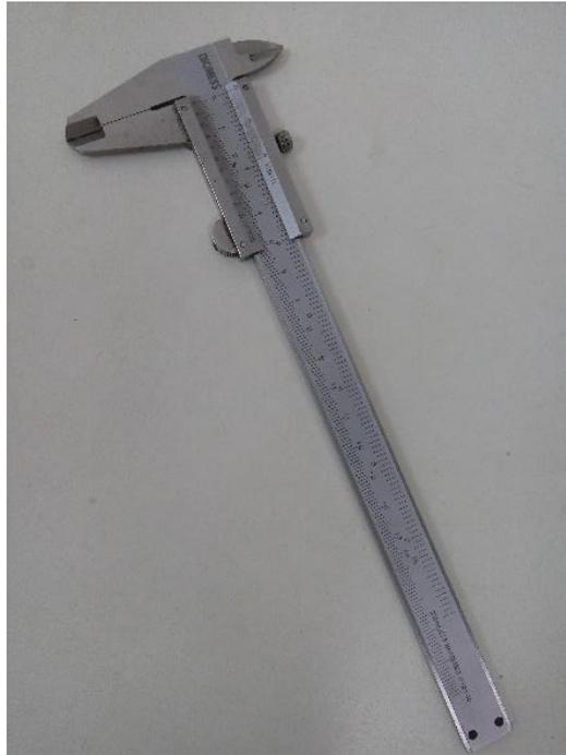
Figura 4.9 - Paquímetro Universal *Digimess*
