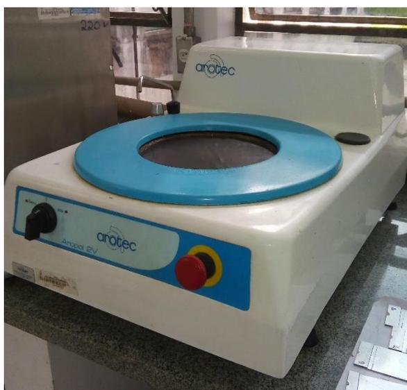
Figura 3.8 – Máquina de lixamento semiautomática utilizada
