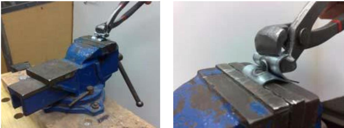
Figura 2.9 - Teste de arrancamento.
