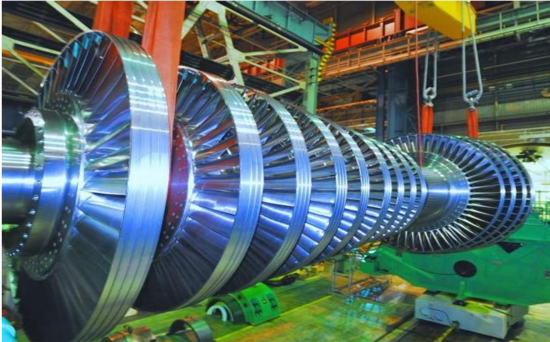
Figura 3.15 - Turbina Nuclear da General Eletric
