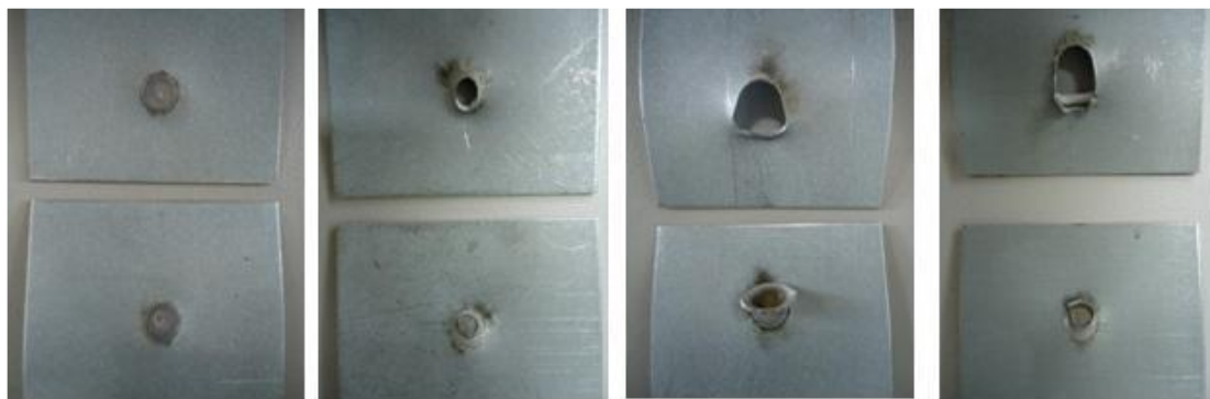
Figura 2.27 - Modos de ruptura: (a) interfacial (b) arrancamento do ponto (c) rasgamento da chapa (d) arrancamento do ponto com rasgamento da chapa
