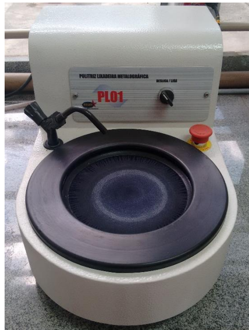
Figura 28. Politriz utilizada no preparo das amostras.
