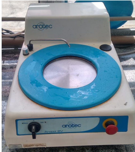
Figura 27. Lixadeira utilizada no preparo das amostras.
