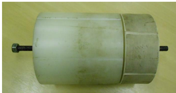
Figura 22. Copo para leitura de corrente de fuga e aplicação de impulsos fechado, da maneira em que são realizados os ensaios.
