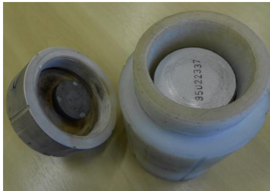
Figura 21. Copo para leitura de corrente de fuga e aplicação de impulsos, com varistor posicionado em seu interior.
