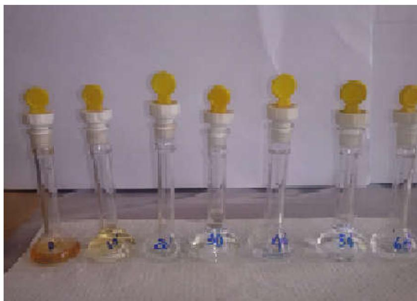
**Figura C2- Detalhes da degradação da cor durante 60 minutos**
