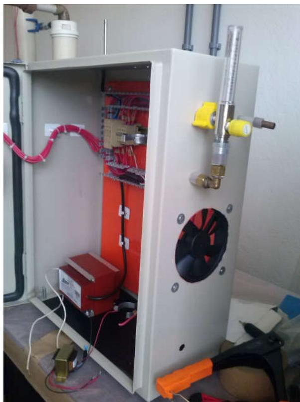
**Figura C4- Detalhe Cooler e transformador 8000 Volts**
