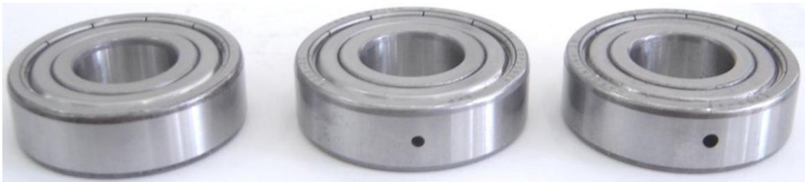
Figura 4-2 – Rolamentos utilizados (da esq. para dir.): normal, falha #1 e falha #2.
