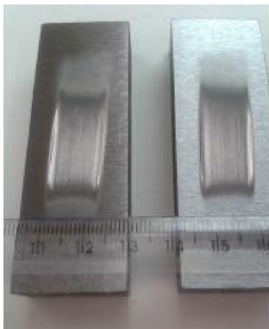
Figura 5.23 - Superfícies de desgaste do aço inoxidável martensítico 11.3/4Cr-3/4Mo-V temperado e revenido, sob baixa carga de ensaio.
