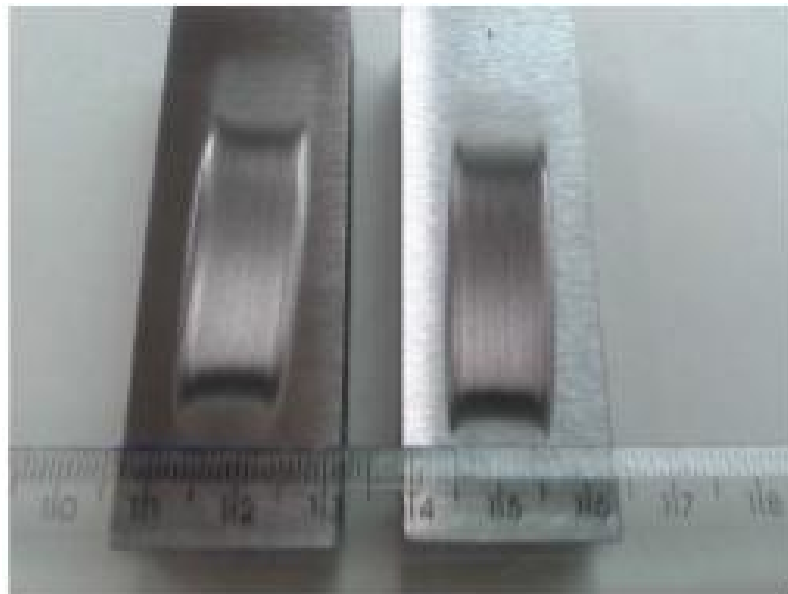
Figura 5.20 - Superfícies de desgaste do aço inoxidável martensítico 11.3/4Cr-3/4Mo-V temperado ao ar e revenido.
