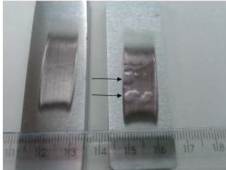
Figura 5.22 - Superfícies de desgaste do CDP do aço inoxidável martensítico 11.3/4Cr-3/4Mo-V com revestimento duro de CoCr sob baixa carga de ensaio.
