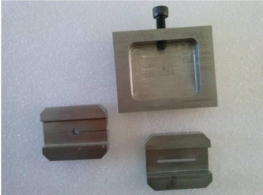
Figura 3.2: Imagem de molde preparado em Aço inoxidável 304L, utilizado para o preparado dos corpos de prova de ensaios de compressão e ensaio de flexão
