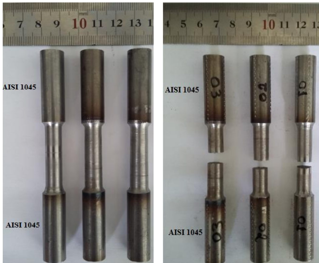
Figura 39 – Corpo de prova 21; 3-1-3. Soldagem similar do aço ASTM 1045 e ensaio de tração
