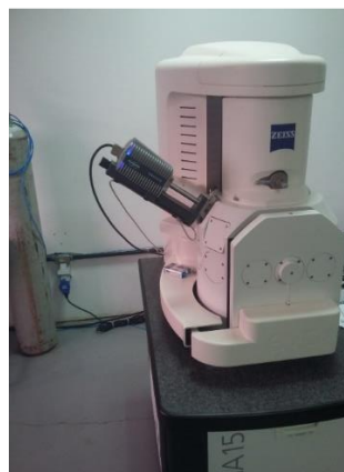
Figura 17 – Microscópio Eletrônico de Varredura – MEV
