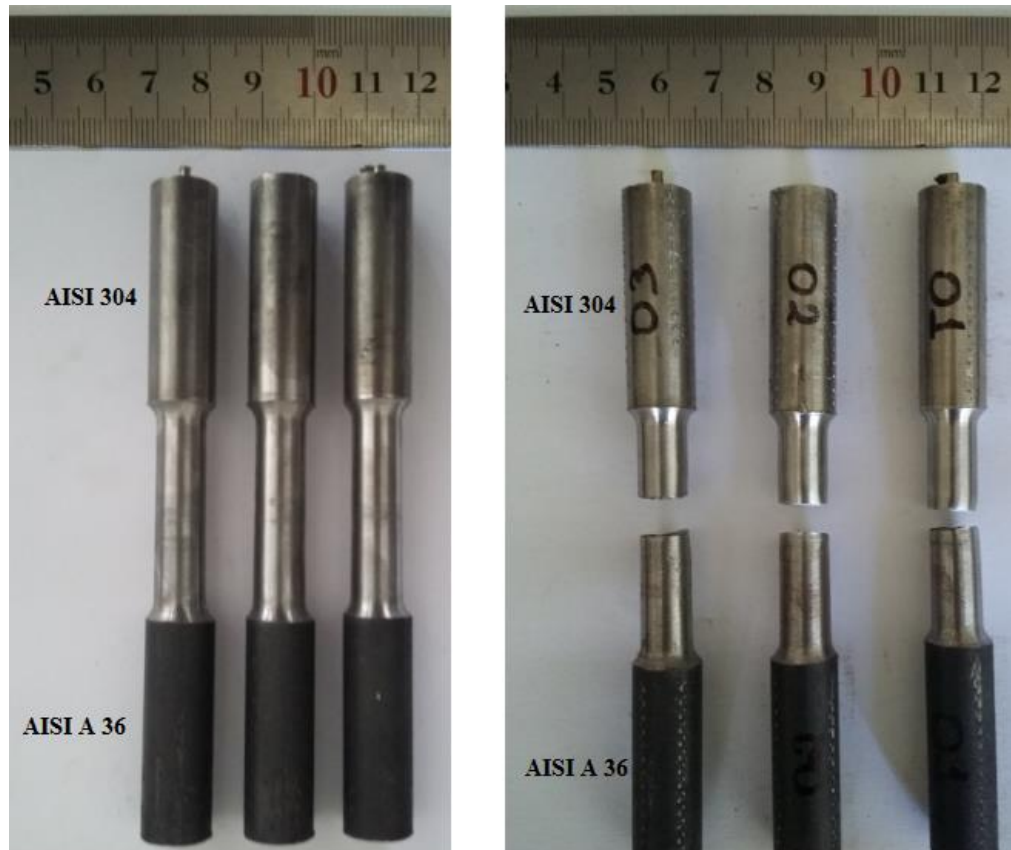
Figura 46 – Corpo de prova 07; 1-3-3. Soldagem dissimilar do aço AISI 304 x ASTM A 36 e ensaio de tração
