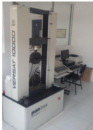
Figura 16 – Máquina universal de ensaio de tração.
