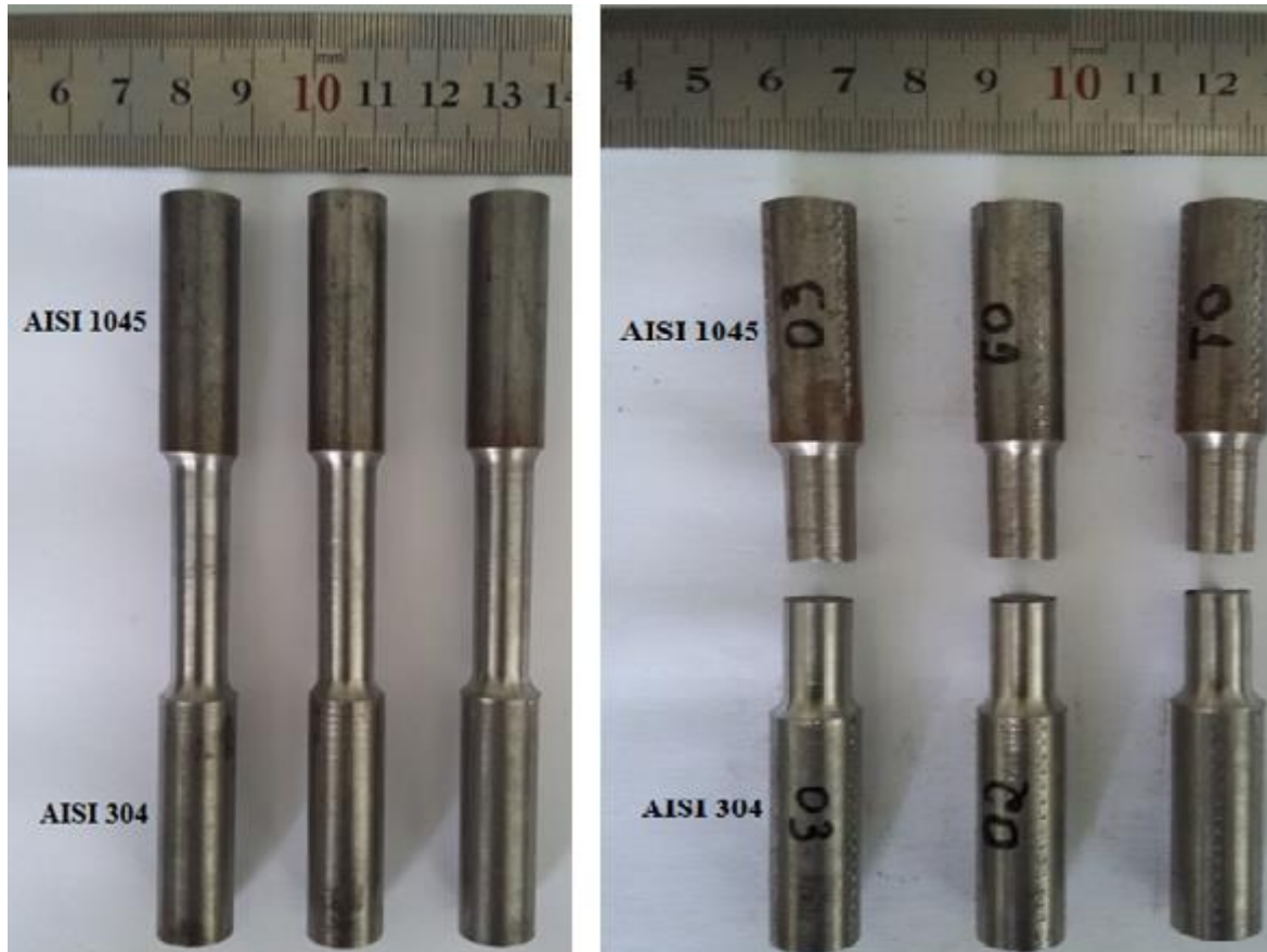
Figura 45 – Corpo de prova 07; 1-3-3. Soldagem dissimilar do aço AISI 304 x ASTM 1045 e ensaio de tração
