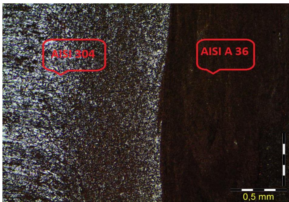
Figura 34 - Região de ligação do aço AISI 304 x ASTM A 36. Corpo de prova 07; 1-3-1 com aumento de 50 vezes
