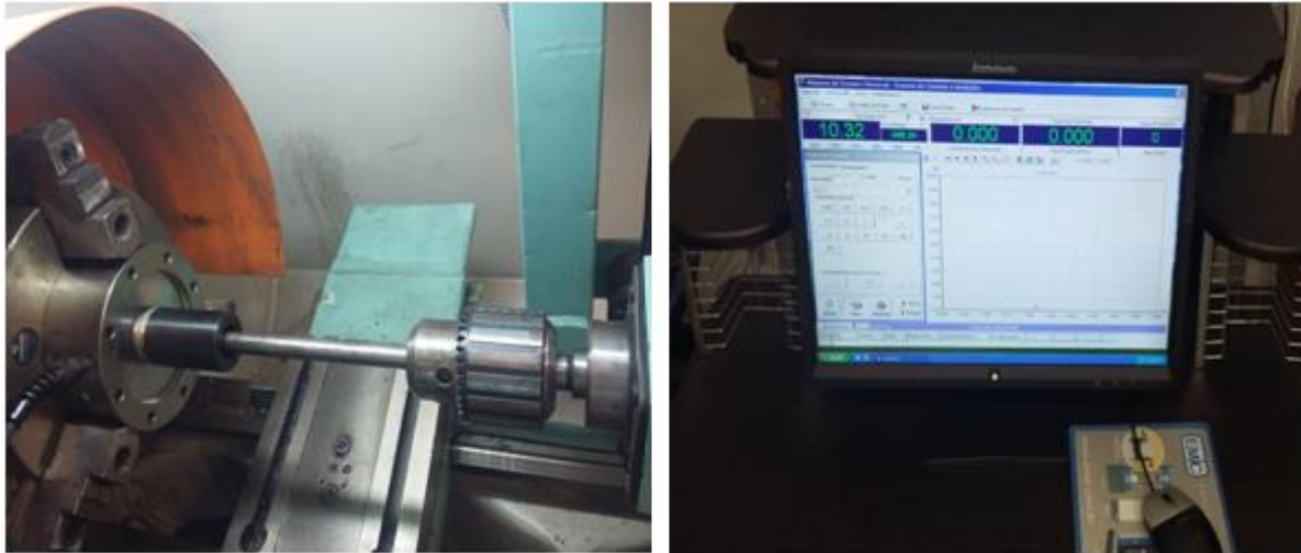
Figura 13 - Parametrização das pressões utilizadas por meio de células de carga.
