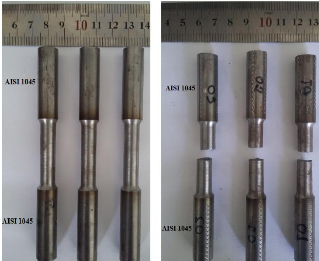
Figura 41 – Corpo de prova 25; 3-3-1. Soldagem similar do aço ASTM 1045 e ensaio de tração
