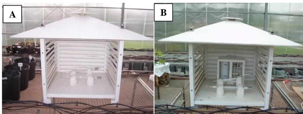
**Figura 4** - Termômetro de mínima de álcool (a frente) e termômetro de máxima de mercúrio (ao fundo) no E1 (painel A) e termômetro de mínima de álcool (a frente) e termômetro de máxima de mercúrio (ao fundo), juntamente com o termohigrógrafo utilizados no E2 (painel B), em casa de vegetação. Itajubá, MG, 2013.
