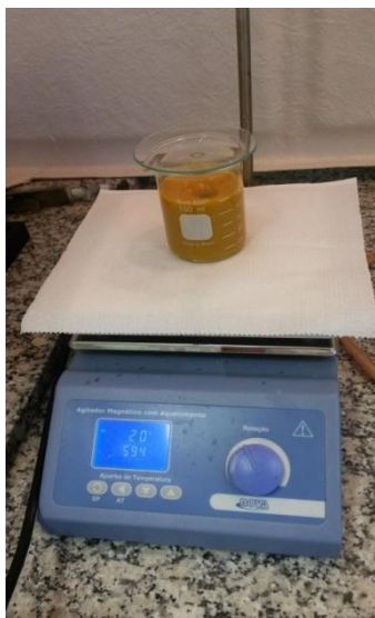
Figura 10 Extração da curcumina pelo método maceração dinâmica.
