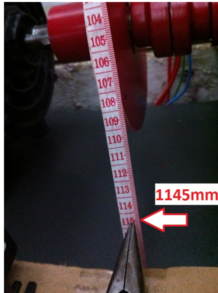
Figura 6.2: Posição referente a 360 graus para máquina síncrona de 4 pólos salientes
