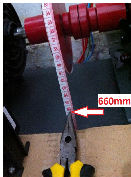
Figura 6.1: Posição referente a 0 graus para máquina síncrona de 4 pólos salientes
