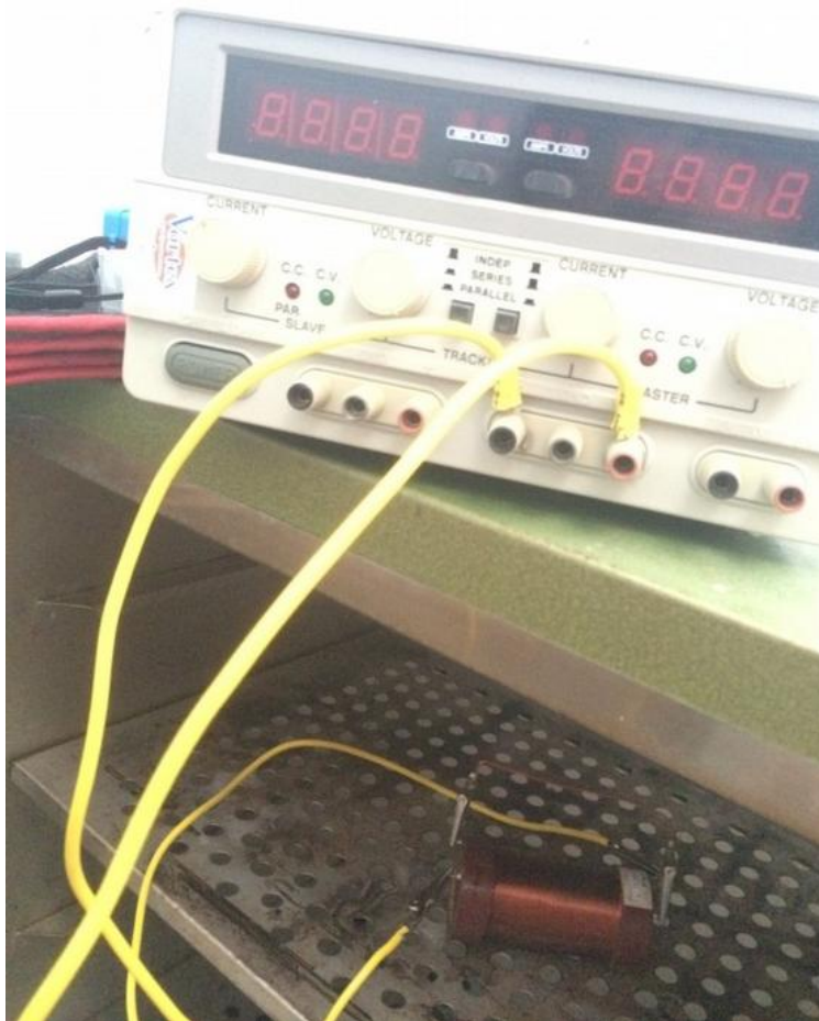
Figura 6.101: Setup de deterioração por dissipação de corrente para o corpo cp4
