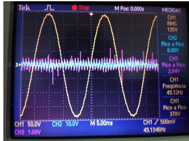
Figura 4.20: Teste de atenuação com acoplamento 25nF-500mH-25nF
