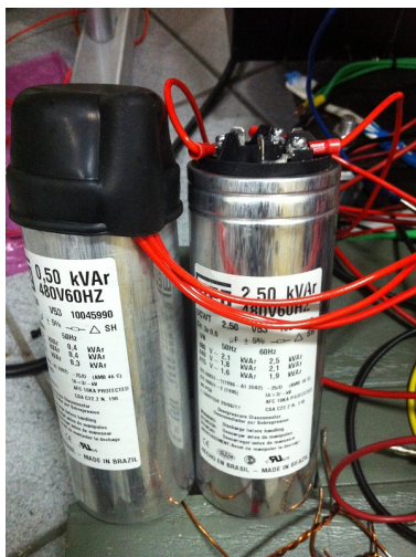
Figura A.1: Banco delta de 3kVAR para a auto-excitação do gerador de indução
