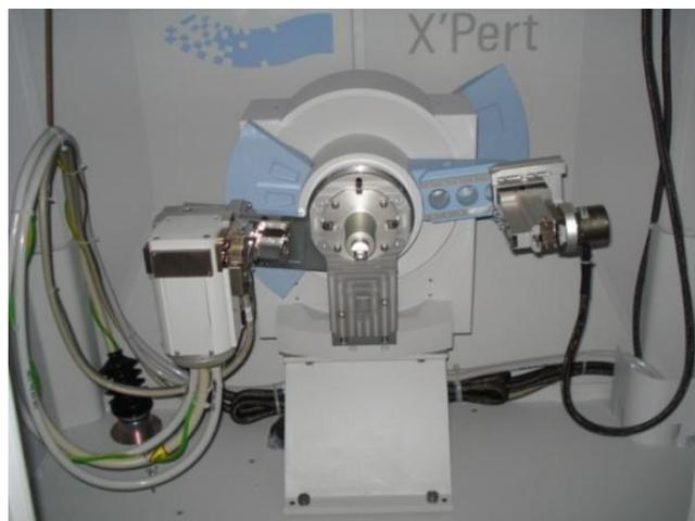
Figura 15: Difratorômetro de raios X (goniômetro, torre e detector)
