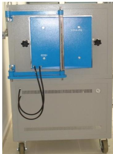
Figura 20: Forno utilizado para sinterização
