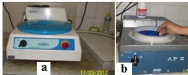
Figura 23: Lixadeira automática Lixadeira Marca Arotec, Modelo Aropol 2V e Politriz Marca Struers, Modelo AP2 500 rpm
