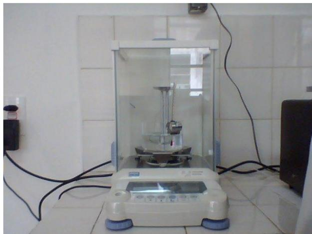
Figura 21: Balança utilizada para a determinação da densidade aparente
