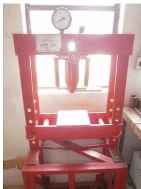
Figura 19: Prensa uniaxial com capacidade de 10T.
