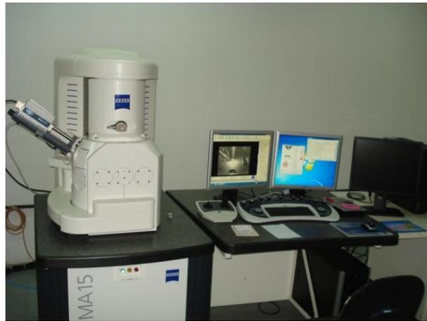
Figura 16: Microscópio eletrônico de varredura.
