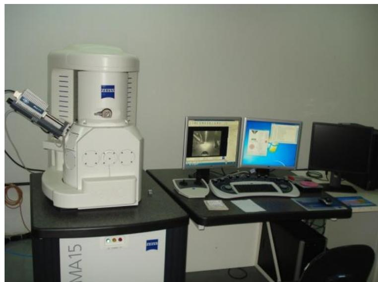
Figura 25: Microscópio Eletrônico de Varredura.
