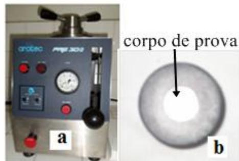
Figura 22: a) Embutidora Marca Arotec, Modelo PRE 30Q e b) amostra embutida
