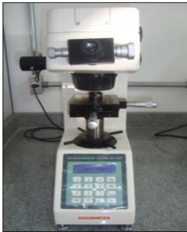
Figura 30a – Microdurômetro DIGINESS (Microhardness tester HV-1000); b – Análise de microdureza (esquemático)
