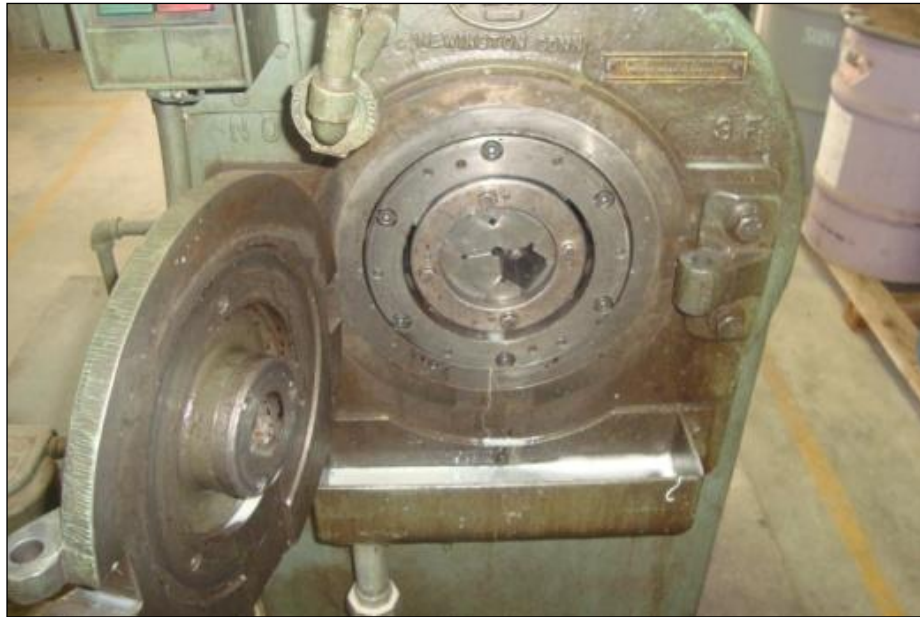
Figura 26 - Máquina de Forjamento Rotativo DEMAR – EEL USP
