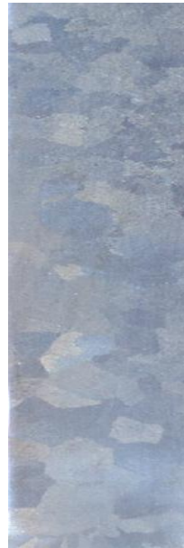
Figura 24 – Al 4,5% Cu após desmoldagem solidificação convencional
