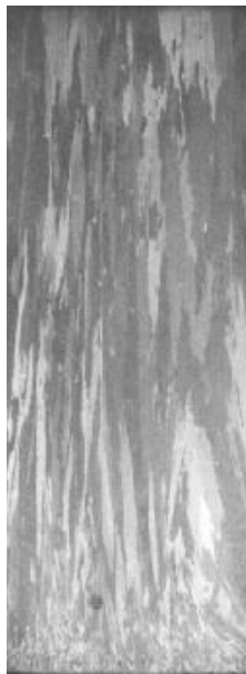
Figura 31 – Al 4,5% Cu como recebida solidificada unidirecionalmente de forma vertical ascendente
