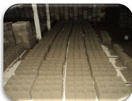
Figura 3.14: Blocos alocados na área de cura
