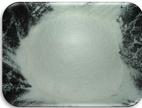
Figura 3.8: Granulometria do Isopor após o processo de moagem
