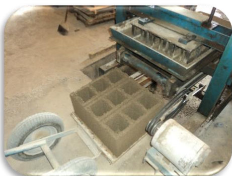
Figura 3.12: Retirada dos blocos da máquina vibro prensa
