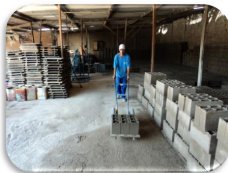
Figura 3.13: Transporte dos blocos para a área de cura
