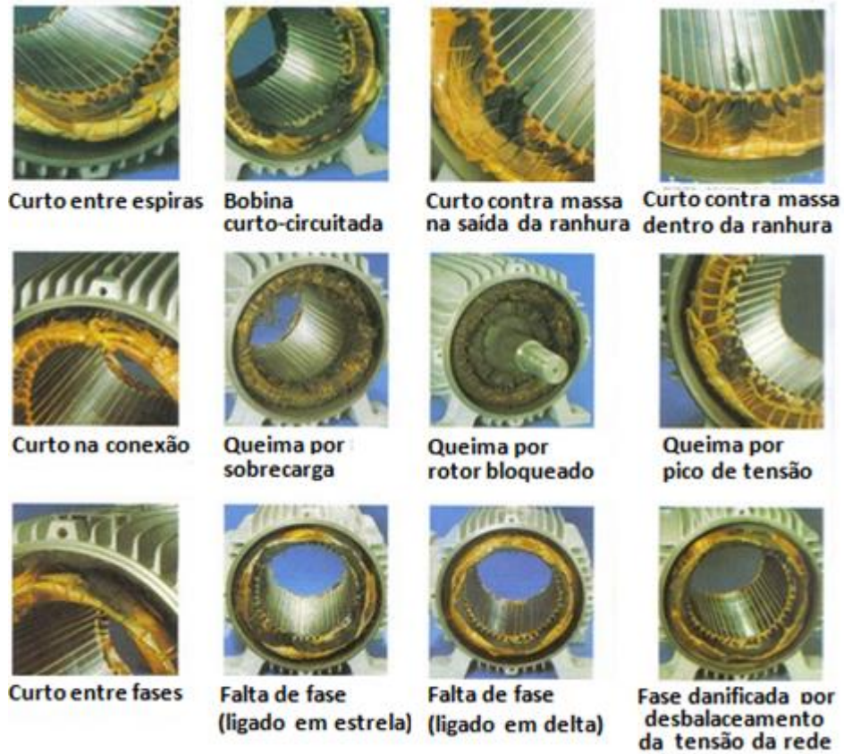
Figura 1.11 - Falhas nos enrolamentos do estator de um motor de indução [8]
