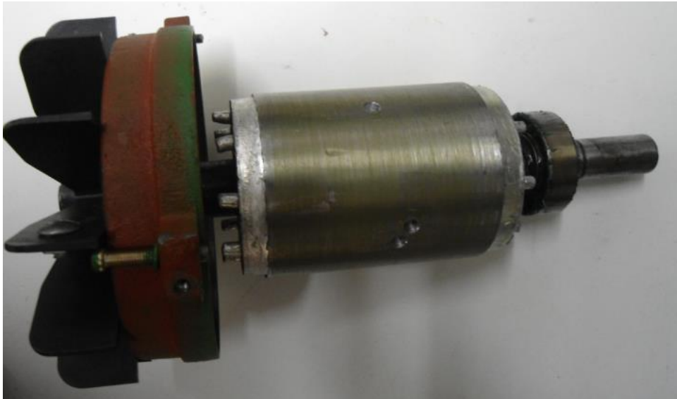
Figura 4.9 - Rotor com barras quebradas
