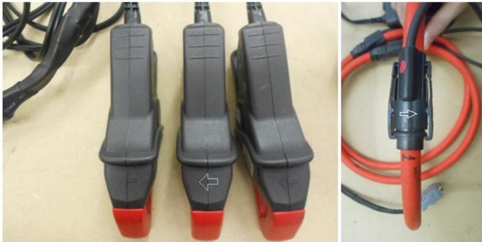
Figura 3.10 - Indicação do sentido da corrente nas garras amperimétricas
