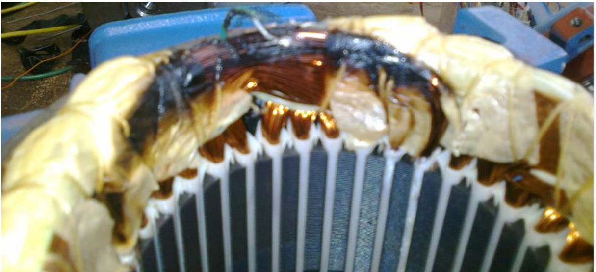
Figura 4.12 - Motor com curto entre espiras
