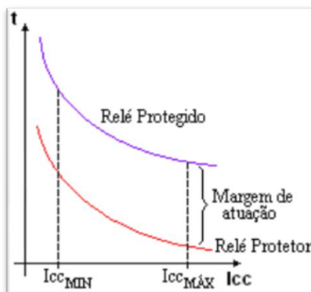
Figura 3.16 - Margem de Atuação: Relé – Relé (PEREIRA, 2007).
