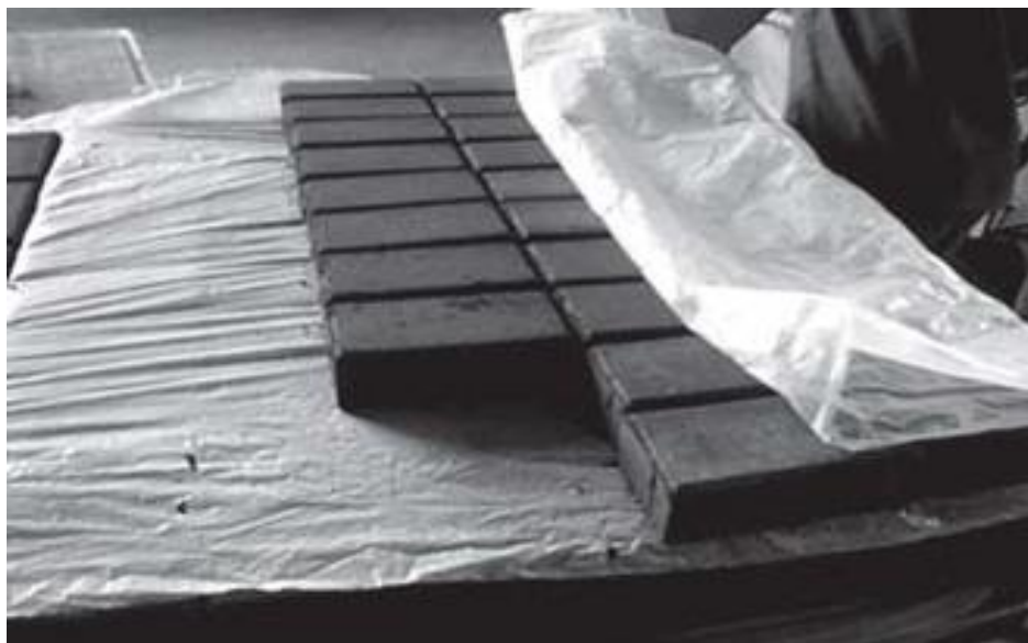
Figura 2.8-A areia de fundição como agregado em artefatos de concreto. Fonte: ABIFA (1999)
