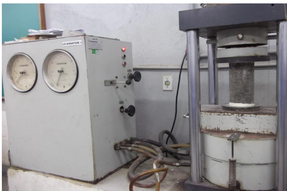
Figura 3.3 - Equipamento usado para os ensaios à compressão axial
