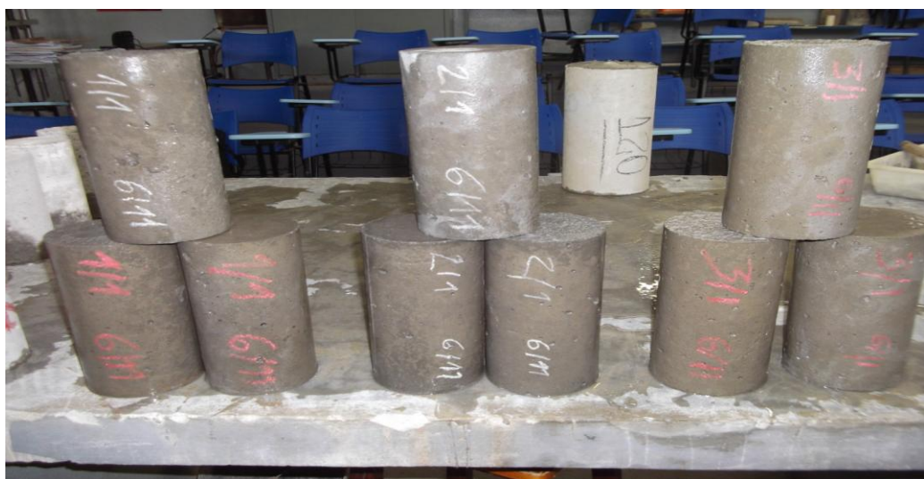
Figura 3.2- Corpos de prova com 1 dia, identificados e prontos para cura de 7, 28 e 35 dias
