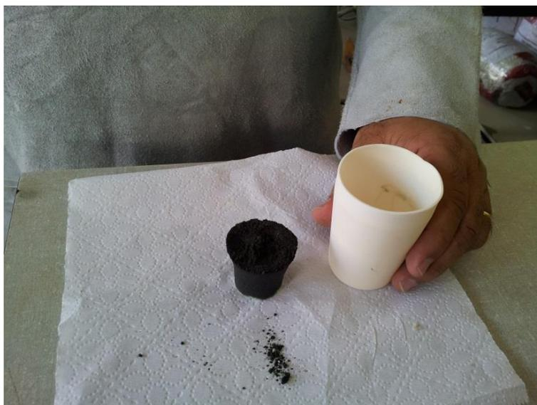
Figura 8.7 – Amostra de clínquer resfriada.
