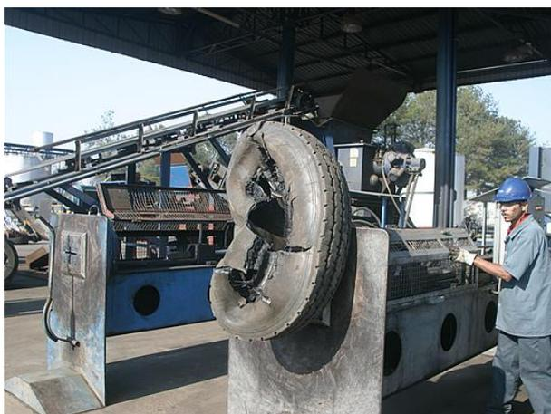
Figura 3.3 – Retirada do aço do pneu
