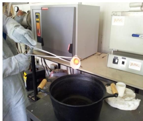
Figura 8.4 – Retirada do clínquer do cadinho após sair do forno para o seu resfriamento.
