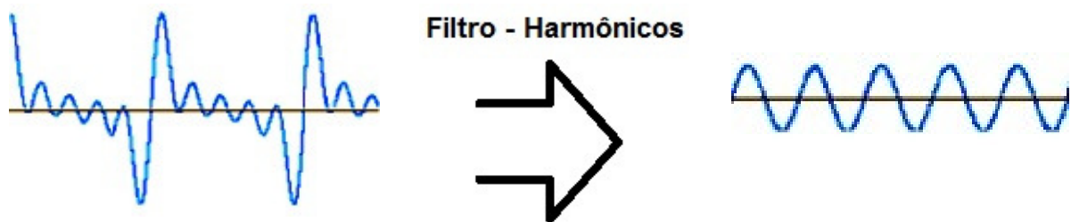
Figura 5.7 – Filtragem dos harmônicos
