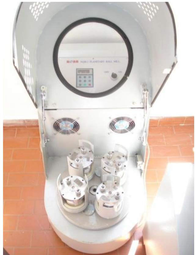
Figura 16 a): Vaso com esferas do moinho de alta energia, 16 b) Moinho de alta energia-Laboratório da UNIFEI
