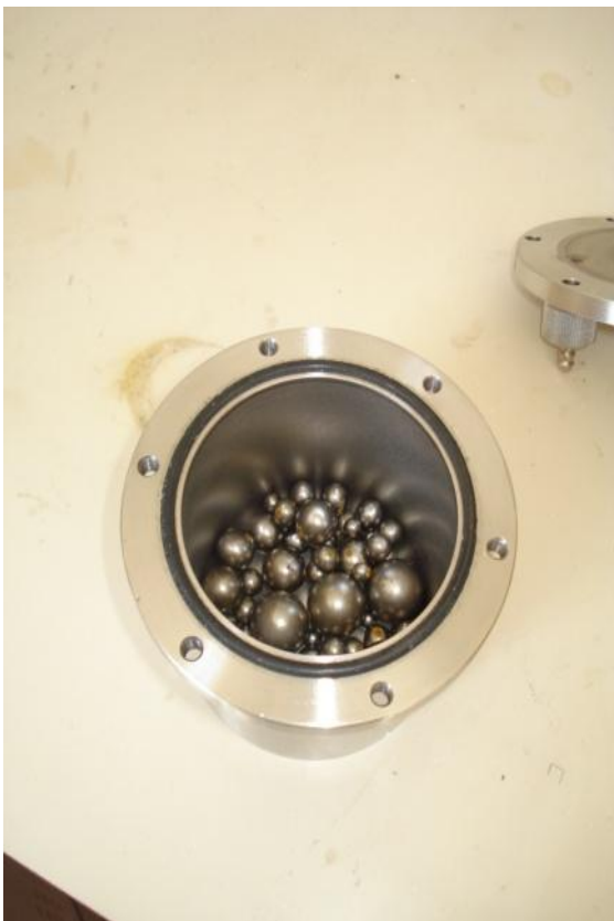
Figura 16 a): Vaso com esferas do moinho de alta energia, 16 b) Moinho de alta energia-Laboratório da UNIFEI
