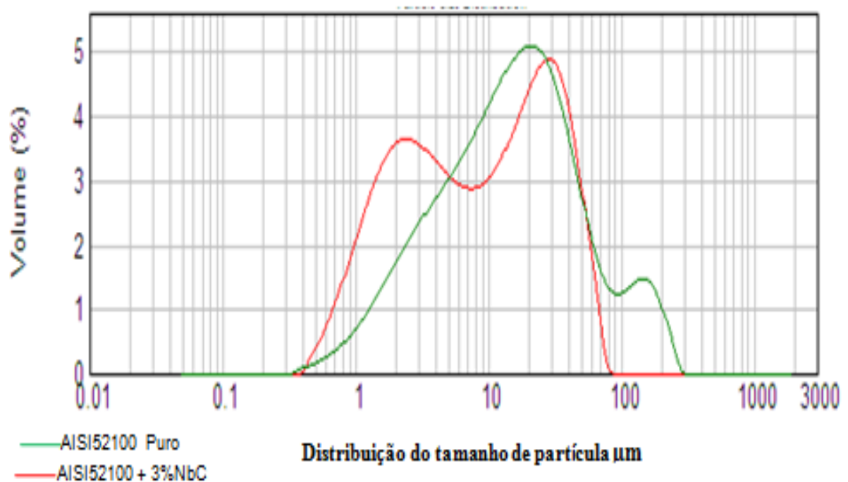
Figura 44: Comparação entre a distribuição do tamanho de partícula do aço AISI 52100 puro e com adição de 3% de NbC.
