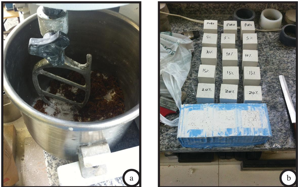
Figura 30 – Desenvolvimento das misturas feitas na batedeira (a) e colocadas no molde (b).
