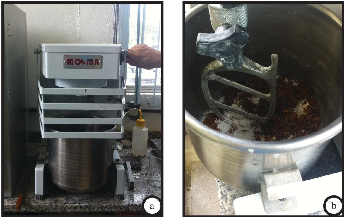
Figura 12 – Foto da bateadeira utilizada modelo Moema (a) nas misturas de gesso com cascas de arroz (b).
