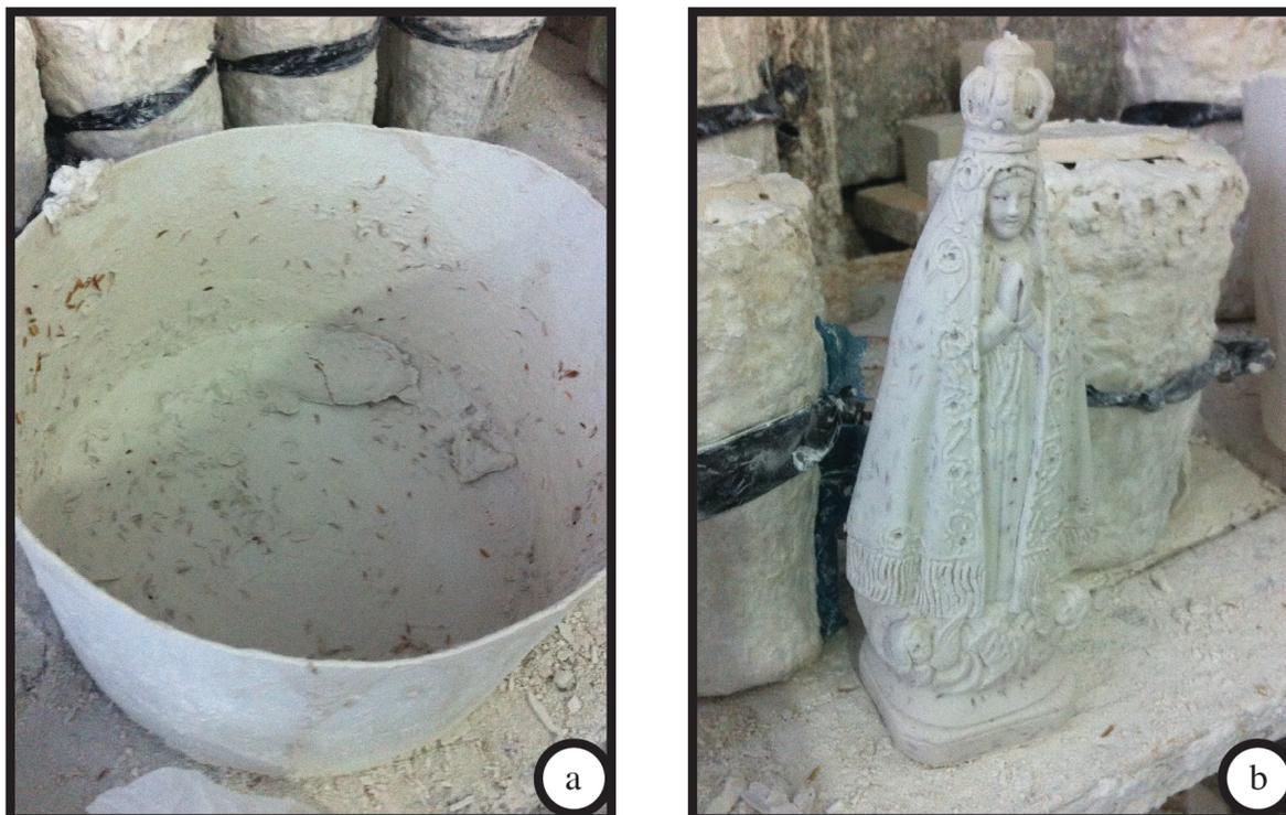
Figura 35 – Mistura do compósito (a) e artefatos desenvolvidos com gesso e cascas de arroz *in natura* (b) na empresa JB.
