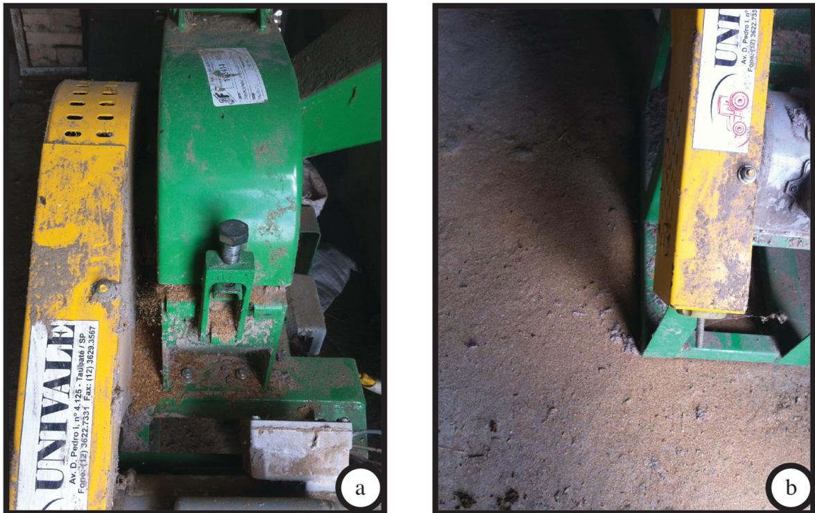
Figura 15 – Ausência de um aparelho de sucção no triturador (a) faz as partículas mais finas se depositarem no chão (b).
