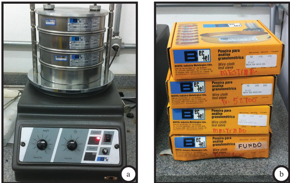
Figura 10 – Foto do equipamento agitador (a) e as peneiras utilizadas com suas especificações (b).
