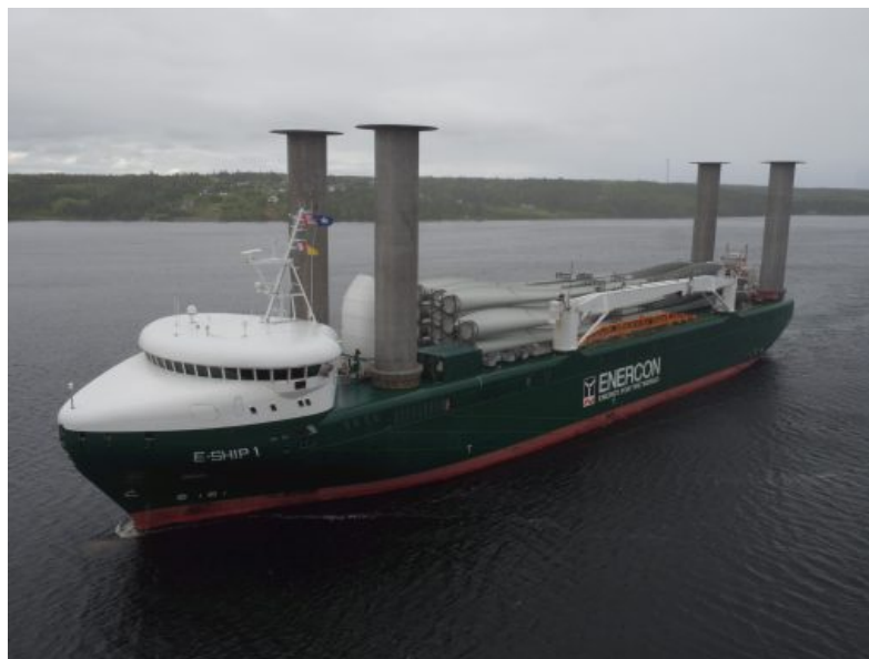
Figura 1.1 – Navio E-Ship 1 da companhia Enercon, utilizado para o transporte de componentes de turbinas eólicas. Fonte: < http://glomeep.imo.org/technology/flettner-rotors/ >
